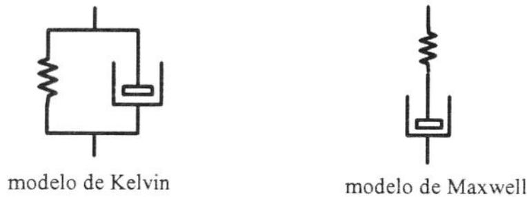
*Fig. D.1 Modelos básicos de viscoelasticidade linear.*
