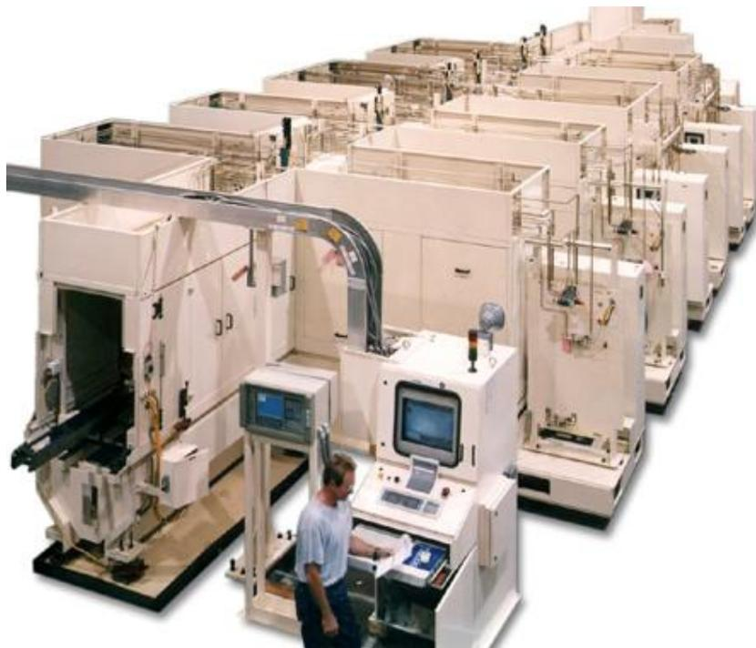
Figura 9: Exemplo de linha tranfer – Ingersoll Production Systems
