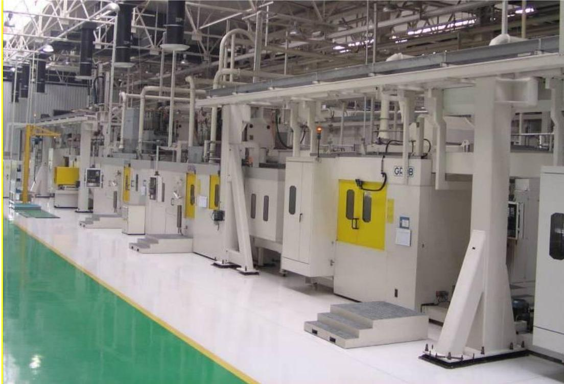
Figura 10: Exemplo de linha flexível com centros de usinagem – B. GROB GmbH
