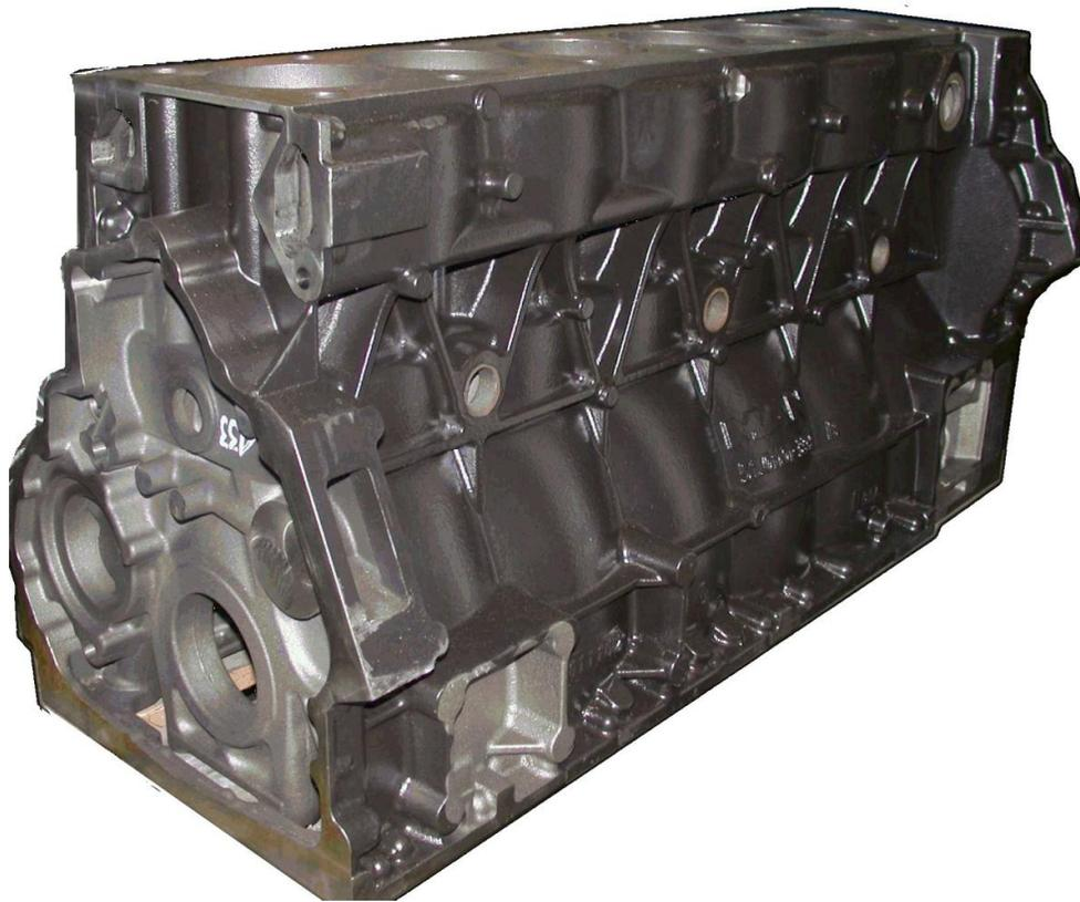
Figura 22: Ilustração do bloco de motor a ser manufaturado
