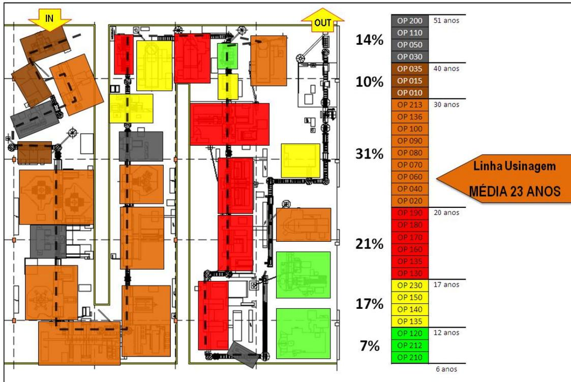
Figura 27: Layout de uma linha de usinagem do fabricante em questão com tempo de utilização dos equipamentos alocados – Adaptado de dados do fabricante.
