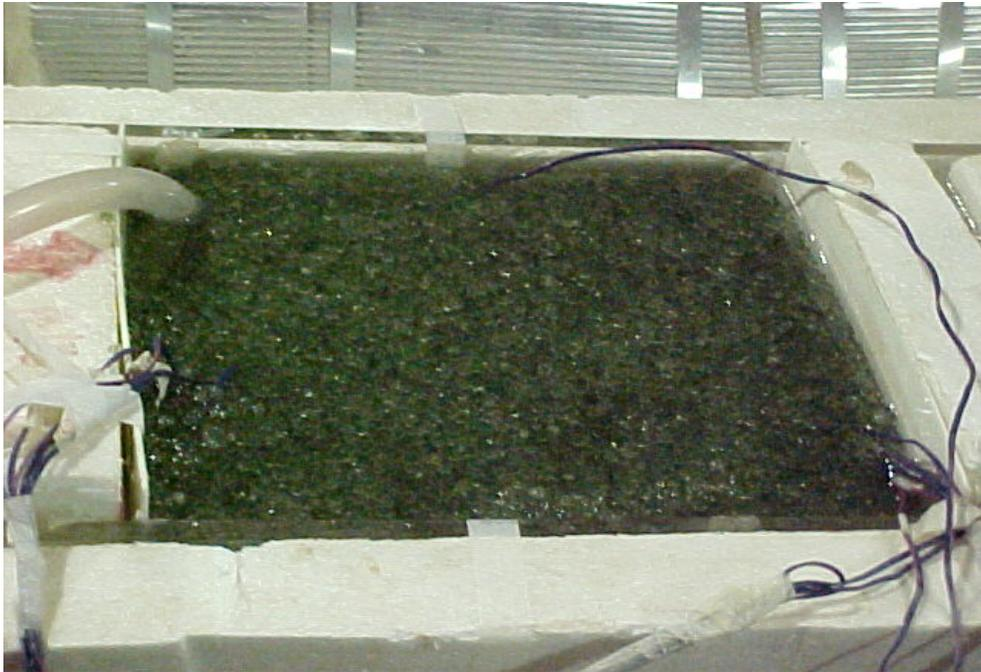
Figura 3.3 – Fotografia da seção de testes preenchida por água e esferas de vidro de 5mm de diâmetro médio.
