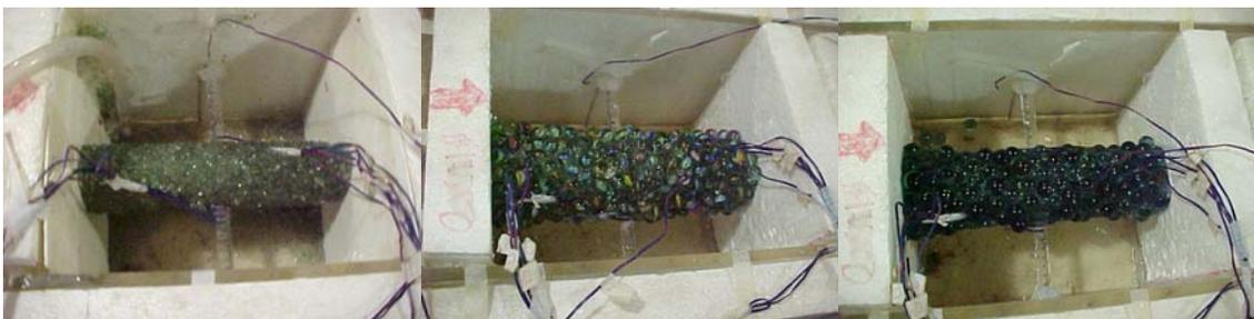
Figura 3.8 – Três tipos de esferas presas ao redor do tubo de cobre após os testes.
