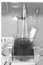
Figura 13. Banho de deposição eletrolítica usado, com ímãs presos na lateral da célula de deposição eletrolítica
