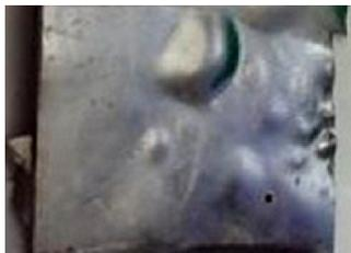
Figura 22. Detalhe do descolamento (bolhas) decorrente da liberação de gases durante a deposição à vácuo de filmes de níquel sobre membranas de PA.
