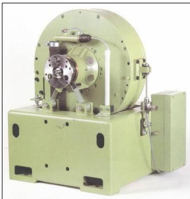
Figura 10: Freio elétrico (por corrente de Foucault)
