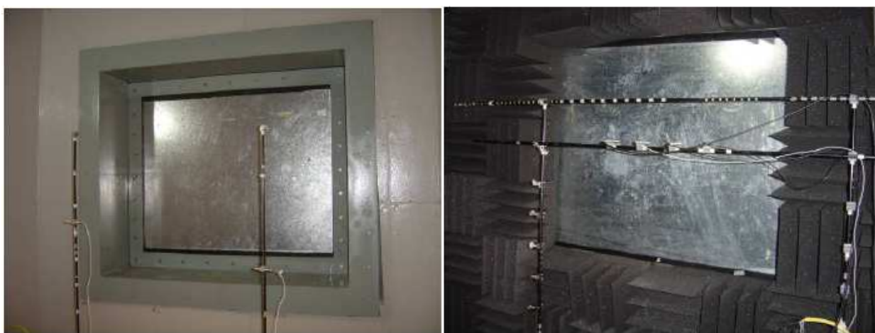
Figura 81 - Vista da placa em medição. Na foto da esquerda, vista da placa de dentro da câmara reverberante. Na foto da direita, vista da placa da câmara anecóica.
