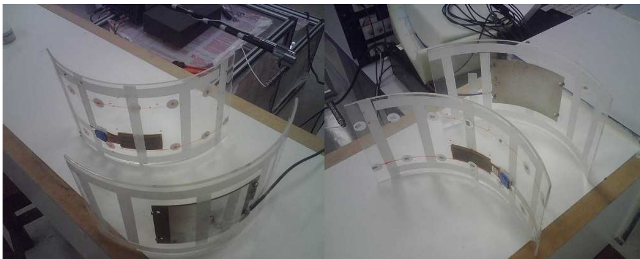
Figura 40 - Fotos das placas acrílicas com a fixação dos transdutores piezelétricos.
