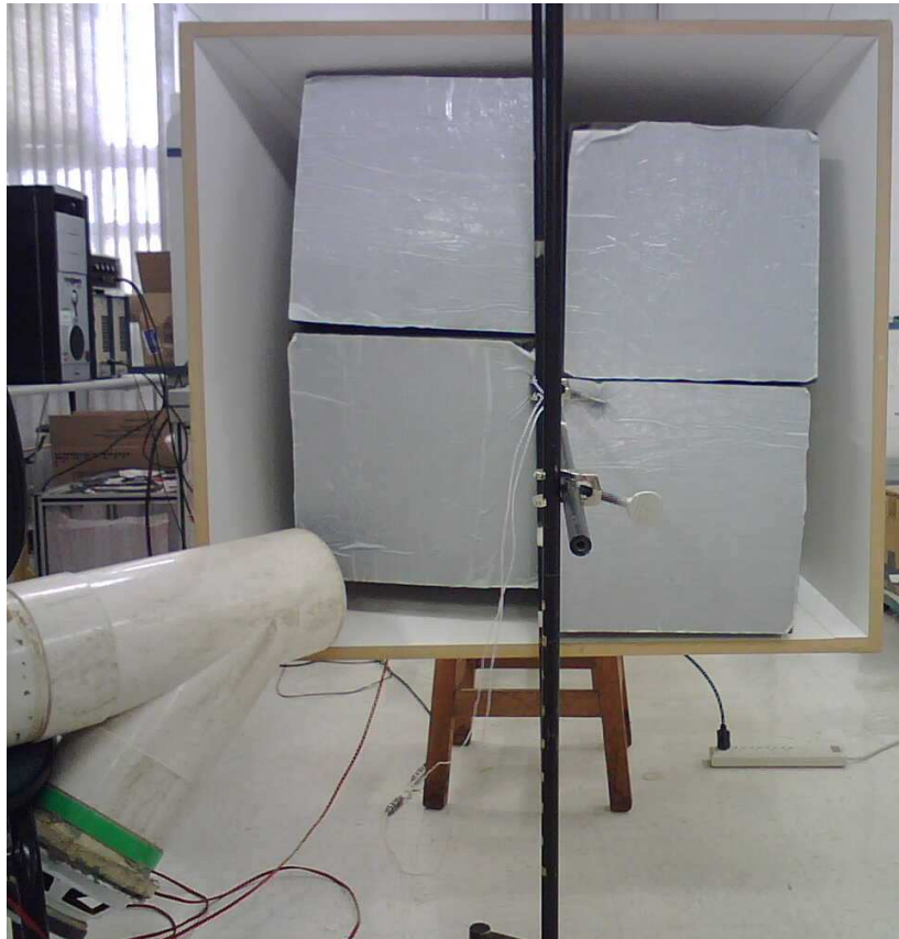
Figura 60 - Terminação do tubo com espumas inseridas na terminação.
