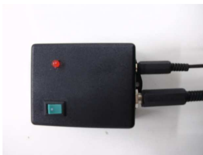
Figura 55 – Caixa onde foi montado o circuito condicionador do sinal do microfone de eletreto.
