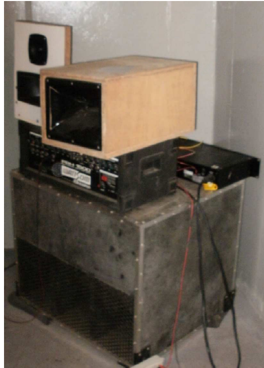
Figura 78 - Sistema de reprodução sonora dentro da câmara reverberante.
