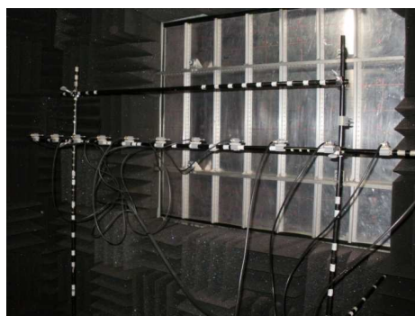
Figura 83 - Foto do painel reforçado fixado à janela entre as câmaras acústicas.
