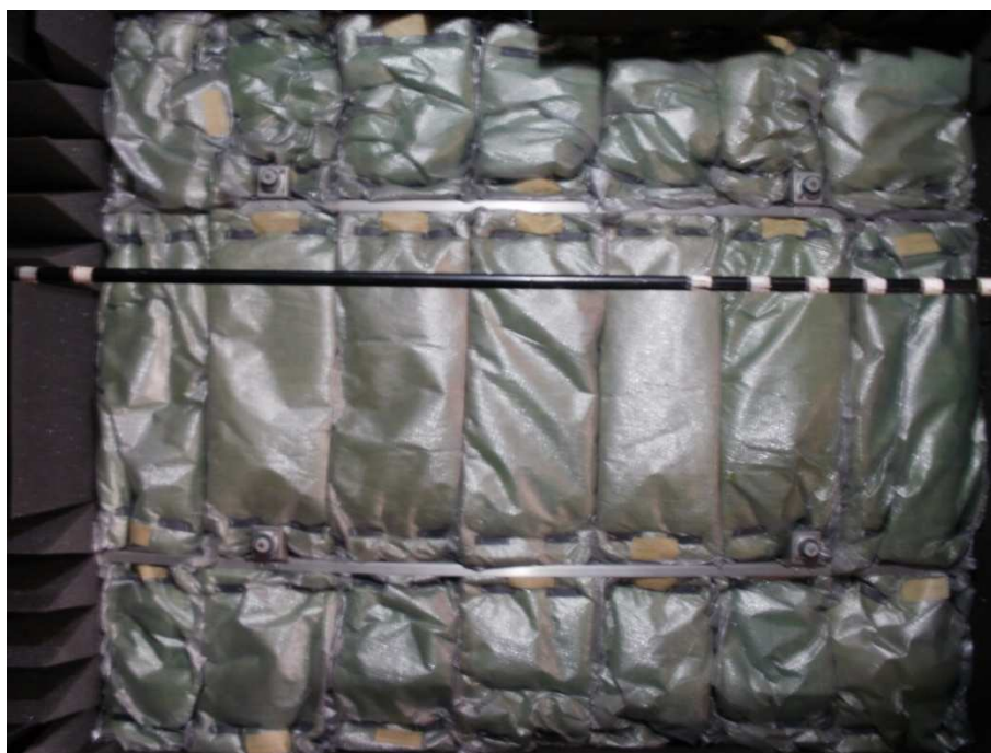
Figura 85 - Painel reforçado com lã de vidro ensacada posicionada nos vãos entre as vigas de reforço da placa.
