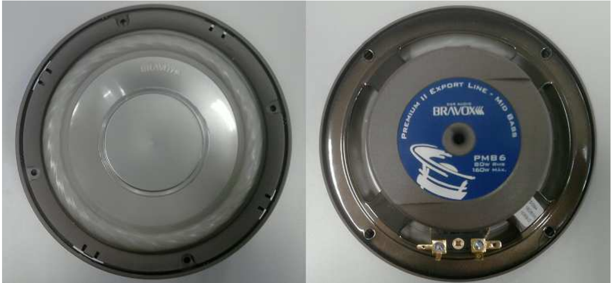
Figura 28 - Alto-falante escolhido como fonte sonora do tubo de ondas planas.
