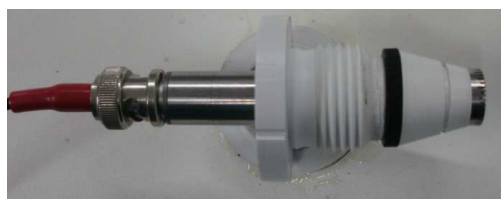
Figura 30 - Foto da flange construída com um microfone dentro.
