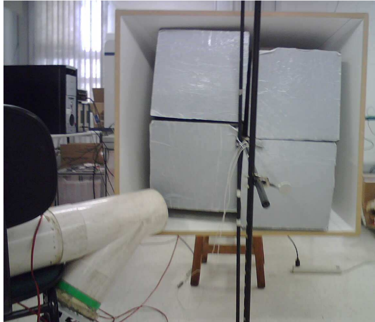
Figura 69 - Foto do tubo de ondas planas com a fonte de ruído exógeno no canto inferior esquerdo.
