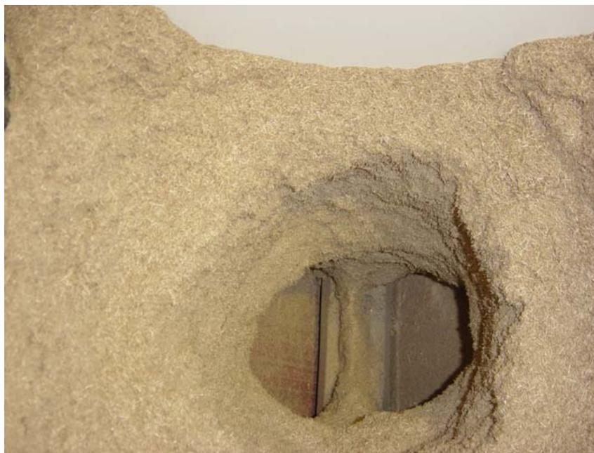
**Figura 3.8:** Quebra do arco mecânico formado no interior do silo de alimentação.
