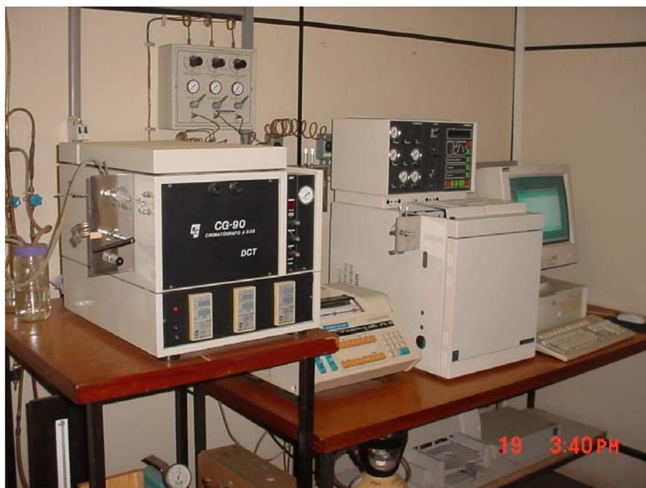
**Figura 3.12:** Cromatógrafo a gás de peneiras empacotadas para a análise dos gases CO, CO<sub>2</sub>, O<sub>2</sub>, CH<sub>4</sub> e N<sub>2</sub>.
