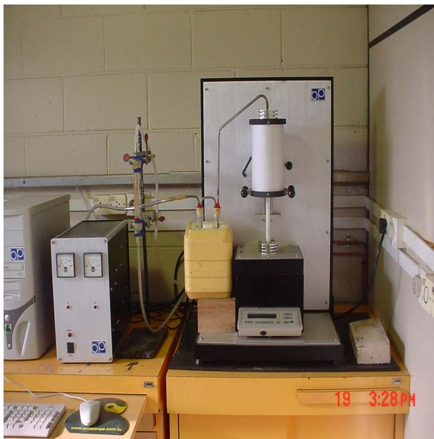
**Figura 3.14:** Balança termogravimétrica (TGA).
