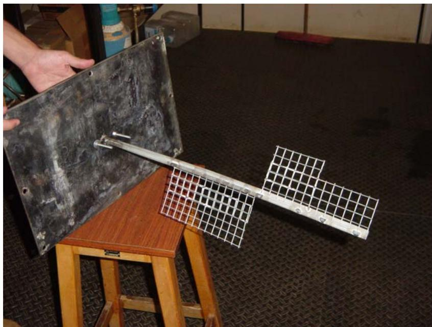
**Figura 3.9:** Dispositivo desenvolvido para a quebra do arco mecânico formado pelo bagaço de cana no interior do silo de alimentação.
