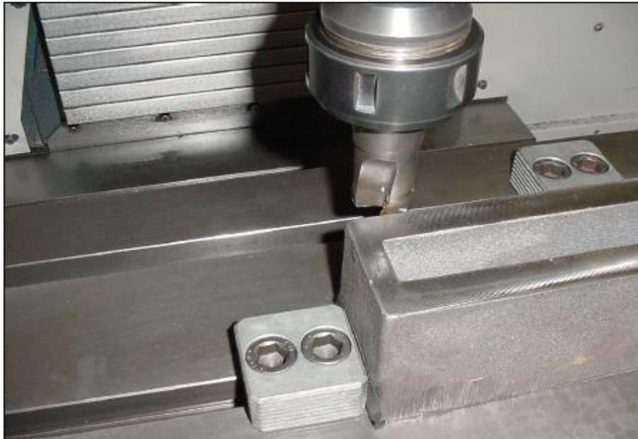
Figura 14 - Representação de fresamento de topo. (SANDVIK, 2003).
