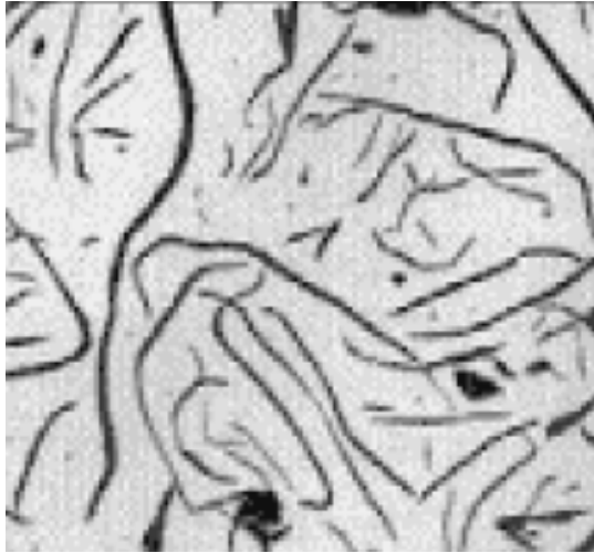
Figura 4 - Grafita Tipo D, tamanho da grafita entre 250 e 500 microns, hipoeutético 100x (RADZIKOWSKA, 2000)
