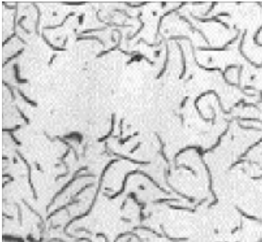
Figura 5 - Flocos de grafita desordenados no ferro fundido cinzento hipereutético, 100x, Tipo B e D, poucas rosetas (RADZIKOWSKA, 2000)
