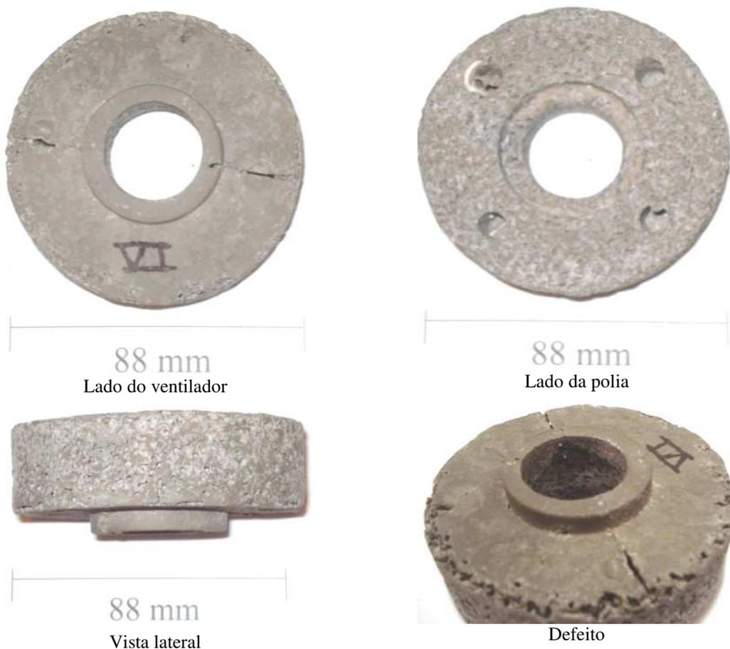
Figura 4.13: Típico componente fabricado por infiltração da liga A356.0 no estado semi-sólido sobre partículas de NaCl de granulometria média; relação de teor percentual em peso de NaCl e liga: 55%/45%. Massa da liga distribuída em duas camadas: 40% na camada interna e 60% sobre as partículas do agente bloqueador.
