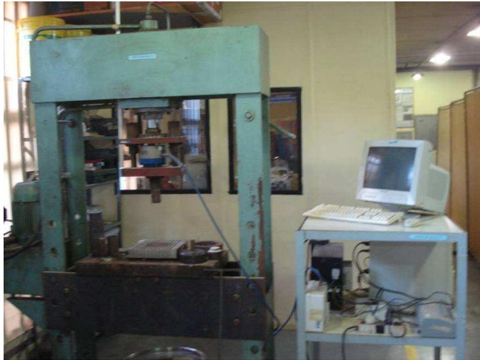
Figura 3.17: Prensa hidráulica e sistema de aquisição de dados utilizados nos ensaios de tixoinfiltração.
