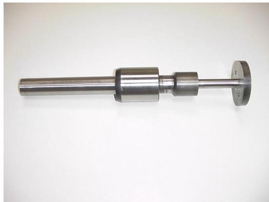
**Figura 6-16 - Exemplo de Poka Yoke Utilizado na Máquina de Testes**
