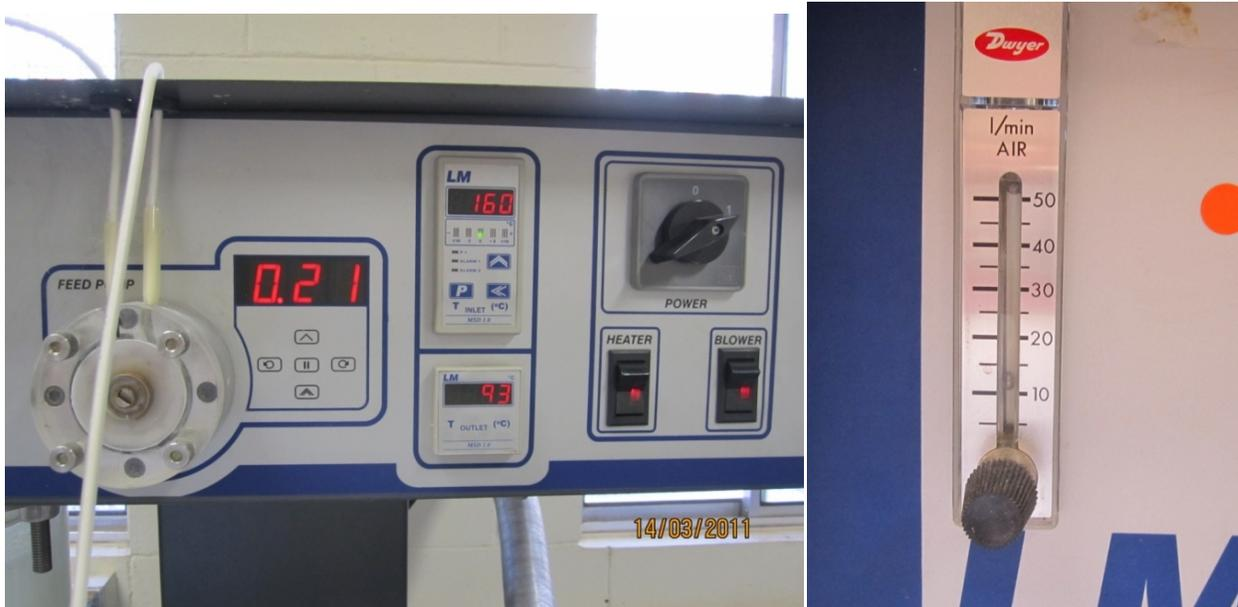
Figura 17 – Detalhe do painel de controle com os parâmetros operacionais do *spray dryer*.
