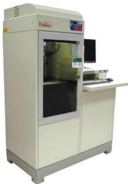
Figura 3 – Equipamento de prototipagem tipo SLA
