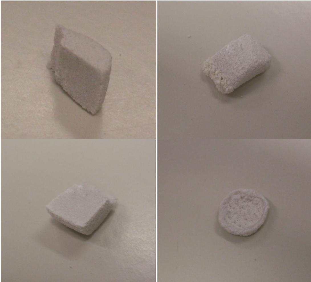
Figura 36 – Corpos de prova experimentais obtidos por prototipagem com a mistura feita pelo processo manual
