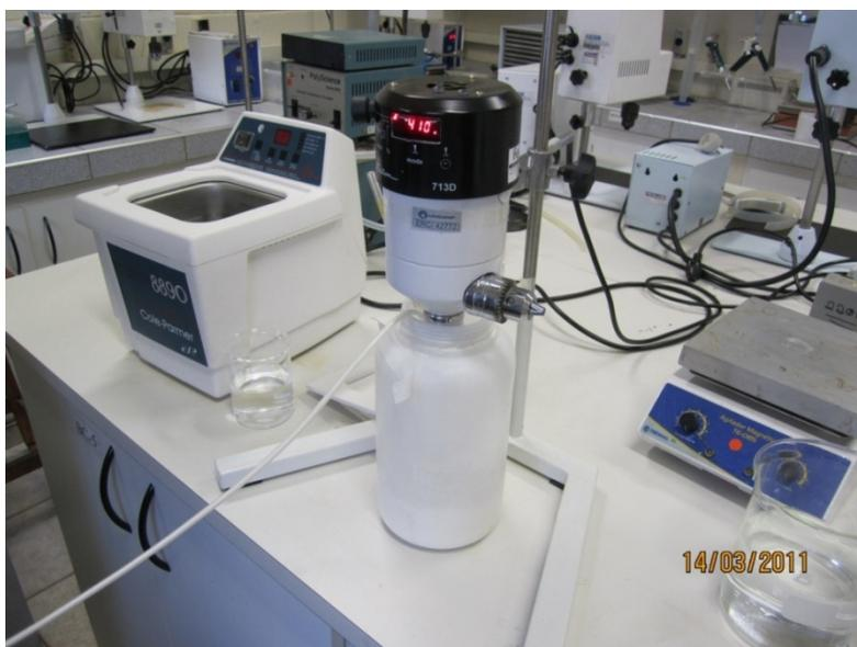
Figura 18 - Agitador mecânico mantendo a solução em movimento
