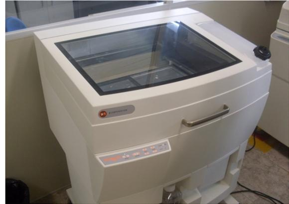
Figura 8 – Equipamento de prototipagem tipo 3DP da Z Corporation.
