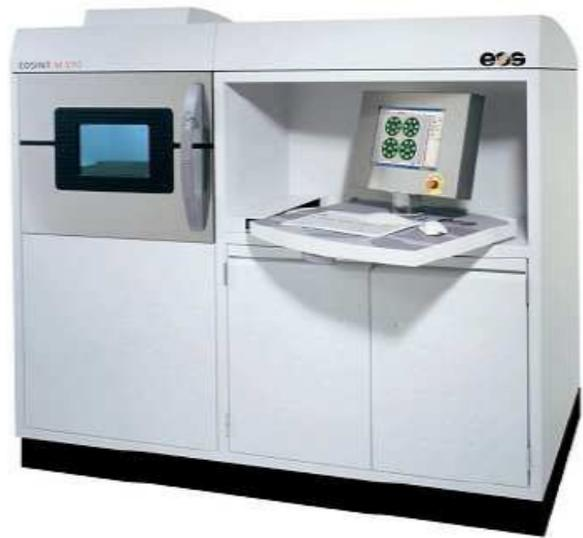
Figura 6 – Equipamento de prototipagem tipo DMLS da EOS
