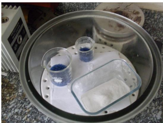
Figura 15 - Armazenamento do material em dessecador
