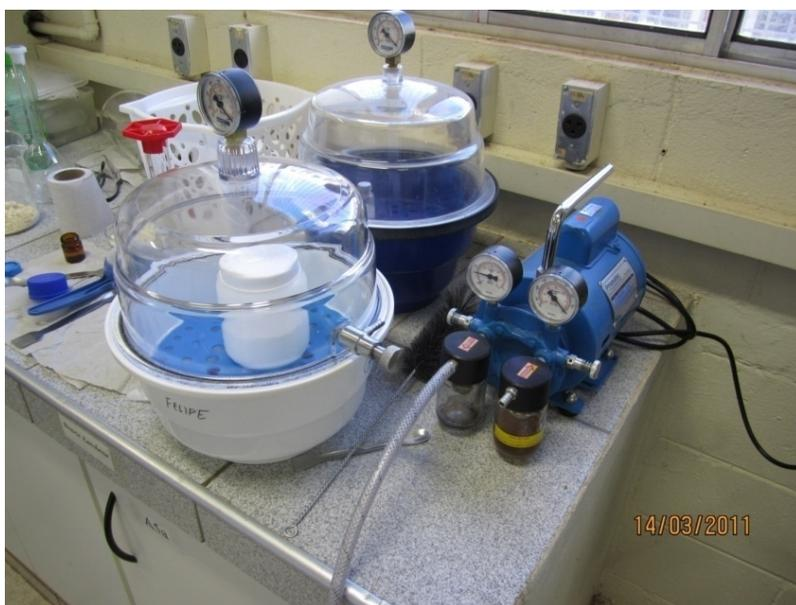
Figura 19 - Armazenamento do material preparado em dessecador com sílica gel
