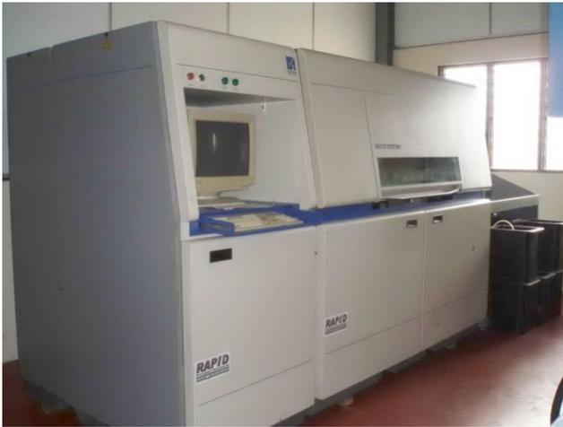
Figura 2 – Equipamento de prototipagem tipo SLS
