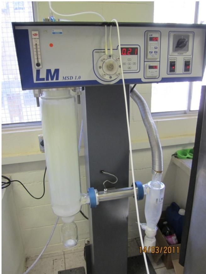
Figura 16 - Equipamento de spray dryer durante processo de secagem
