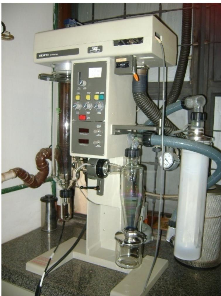
Figura 12 – Equipamento de *spray dryer* utilizado
