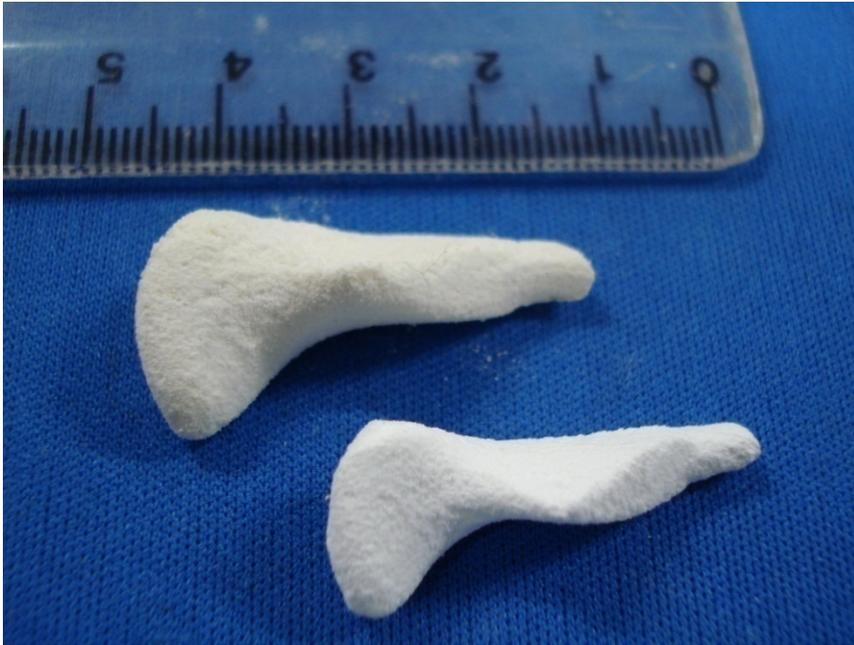
Figura 38 - Corpos de prova prototipados, sinterizado (abaixo) e não sinterizado (acima).
