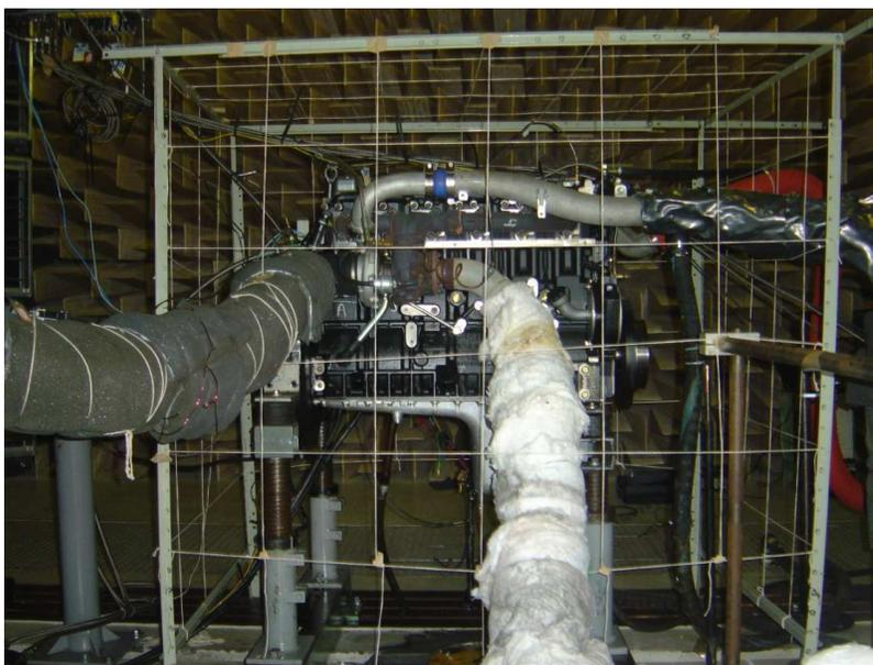
Figura 4.3 - Malha para medição de intensidade sonora.
