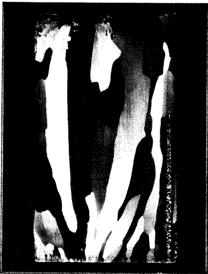
Figura IV.5.b- Macroestrutura de um lingote de chumbo comercialmente puro, solidificado unidirecionalmente em molde refrigerado com aplicação de Dycote 39.
