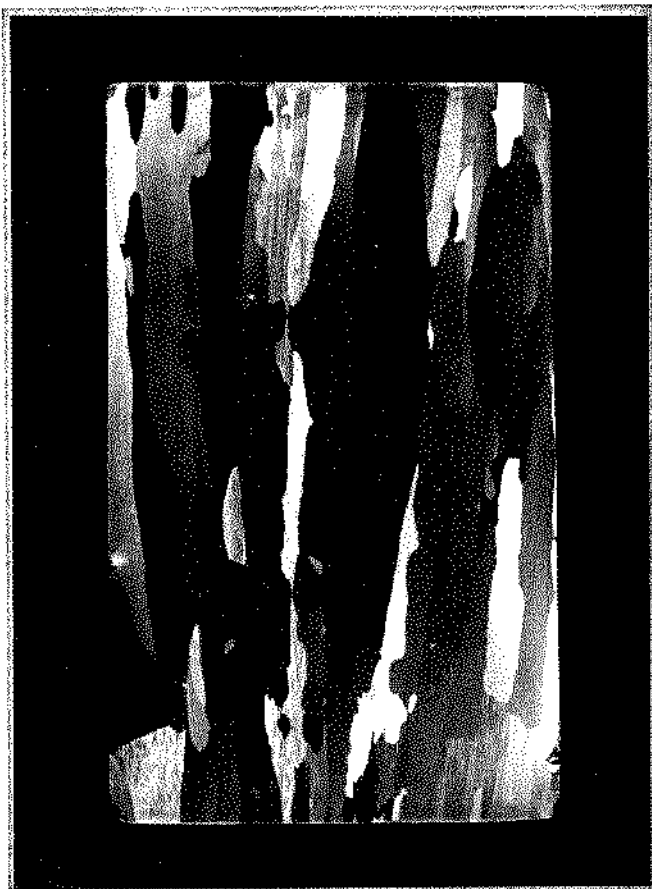
Figura III.5.a- Macroestrutura de um lingote de chumbo comercialmente puro, solidificado unidirecionalmente em molde polido (X 1,1).
