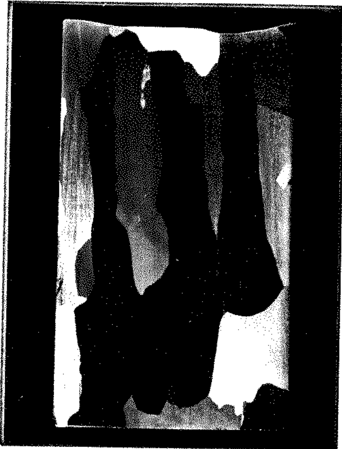
Figura IV.5.c- Macroestrutura de um lingote de chumbo comercialmente puro, solidificado unidirecionalmente em molde refrigerado com aplicação de negro de fumo.
