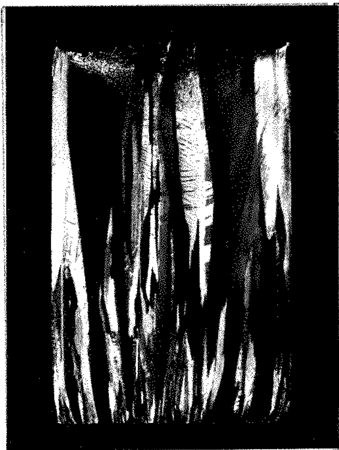
Figura III.5.b- Macroestrutura de um lingote de zinco comercialmente puro solidificado unidirecionalmente em molde polido. (X 1,1)
