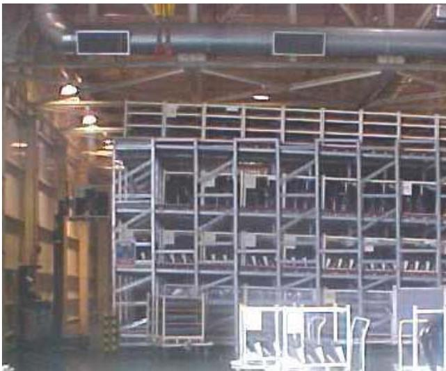
Figura 5-44: *Racks em Fluxo ou Estruturas Dinâmicas*
