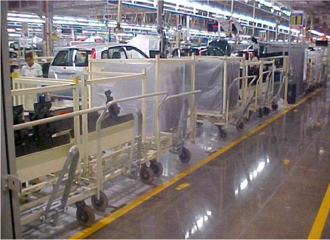
Figura 5-26: Embalagens na Linha de Montagem para *Kanban* de Retirada
