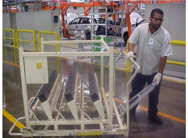
Figura 5-27: Retirada de Embalagem Vazia na Linha de Montagem – Chamada de Reposição
