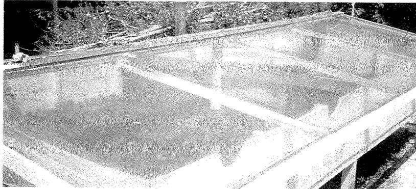
Figura 6. 14: Secador solar de sementes de andiroba.
