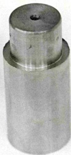
FIG.4.3 - Corpo de prova usinado, destacando-se o furo de centro e diâmetro de fixação.
