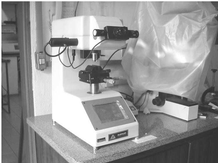
Figura 3.10. Microdurômetro utilizado nos experimentos.
