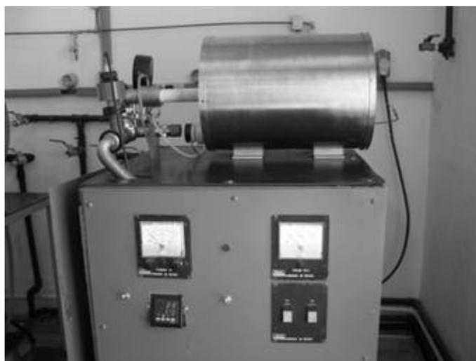
Figura 3.6. Forno de tratamento térmico utilizado nos 7 experimentos.
