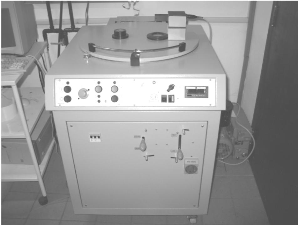
Figura 3.3. Vista externa do equipamento de fundição por centrifugação.
