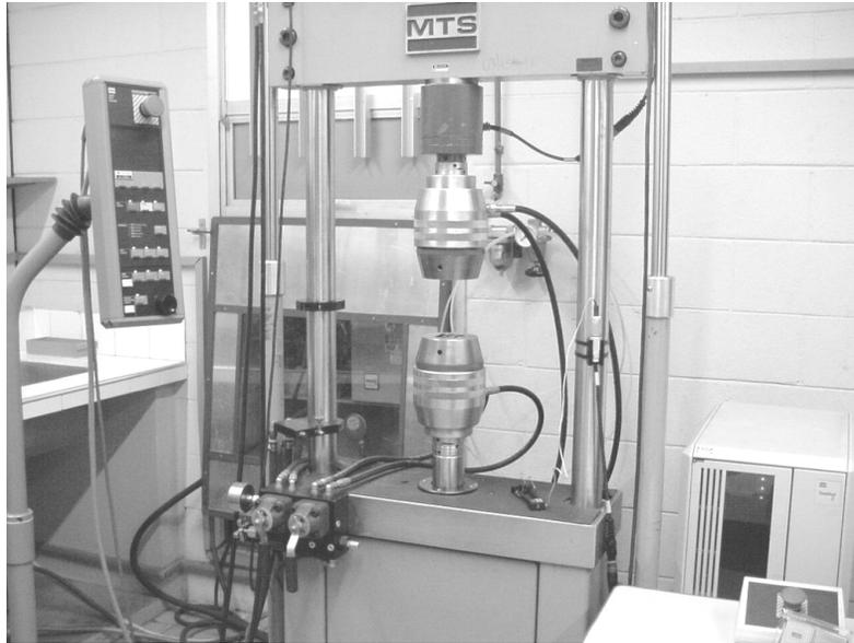
Figura 3.11. Equipamento utilizado nos ensaios de tração das ligas de titânio.
