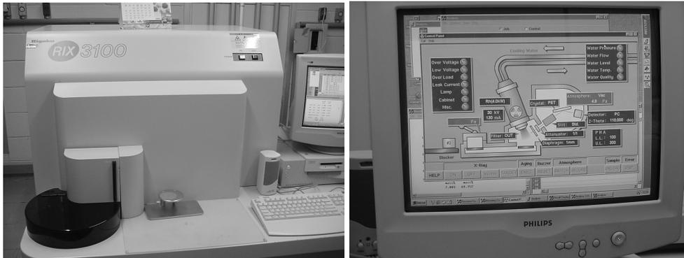
Figura 3.2. Espectrômetro de fluorescência de raios X utilizado nos experimentos.
