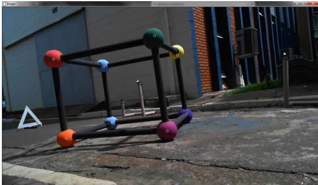
Figura 7.17: Retas obtidas ao processar o lado da caixa que une a esfera laranja com a esfera vermelha.
