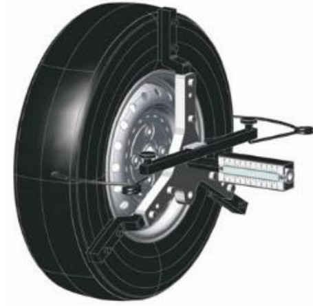
Figura 1.1: Grampo preso na roda (EBERLIN, 2008)
