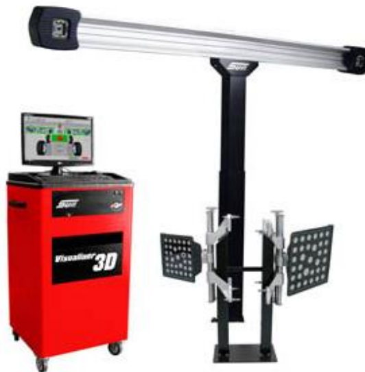
Figura 1.5: O sistema de alinhamento VISUALINER 3D®
