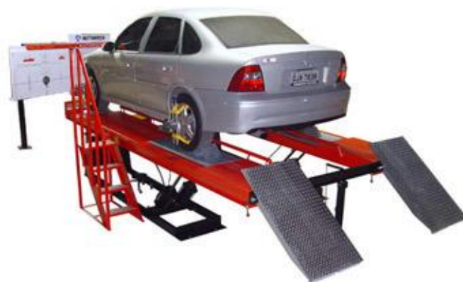
Figura 1.3: Alinhamento feito com painéis e laser. (FENIXCAR)
