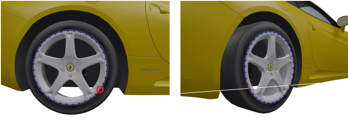
Figura 4.12: Ponto escolhido na imagem esquerda em círculo vermelho, reta epipolar em branco e pontos de interseção com a elipse da imagem direita em vermelho.
