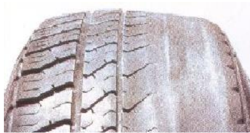
Figura 2.5: Pneu com desgaste devido a camber .
