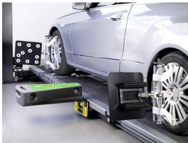
Figura 1.6: Alinhador de rodas FWA 4630
