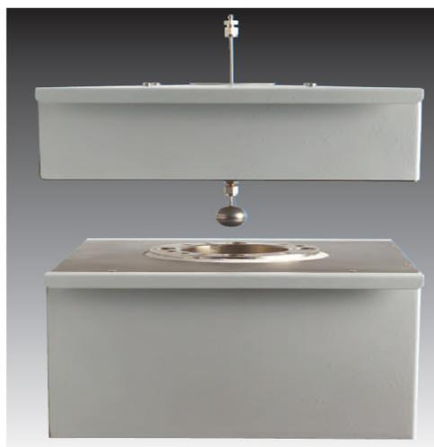
**Figura 3- 10: Forno do Calorímetro [37].**
