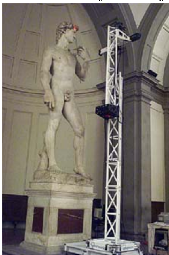
Scanner por triangulação a laser, motorizado e customizado para digitalizar estátuas de grandes dimensões
