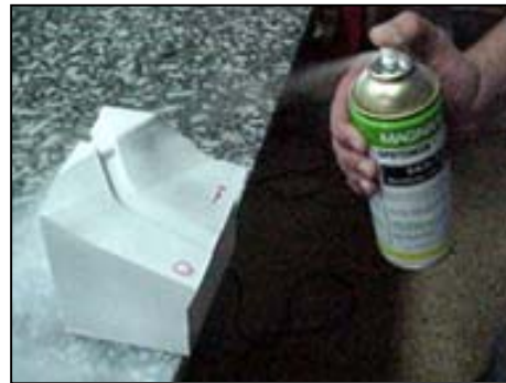
Aplicar pó para evitar a reflexão da luz
