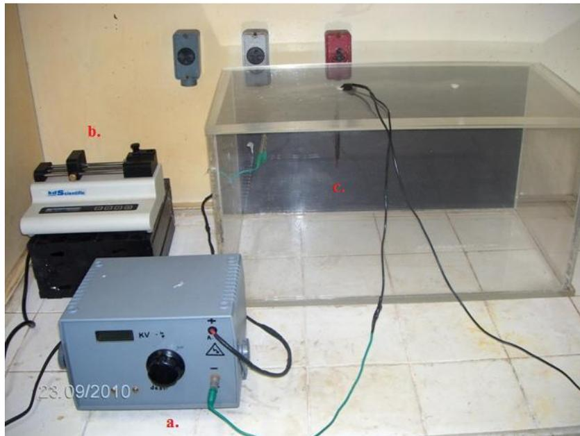
Figura 7: Equipamento montado: a. Fonte de alta tensão b. Bomba de infusão c. Alvo coletor.
