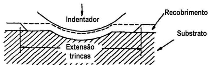
**Figura 2.36:** Esquema do método de indentação para medição da aderência do recobrimento [Bhushan e Gupta, 2001].
