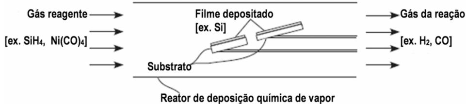
**Figura 2.15:** Esquema do processo de deposição química de vapor (CVD) [Freund e Suresh, 2003].
