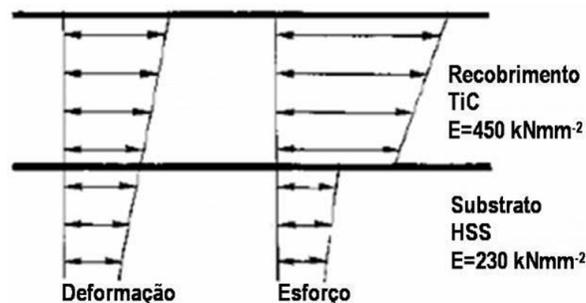
**Figura 2.26:** Esquema da distribuição típica deformação esforço que ocorre quando uma força externa age sobre o sistema recobrimento-substrato, por exemplo, durante um teste de flexão. A descontinuidade da tensão na interface recobrimento-substrato é causada pelas diferenças no módulo de Young do recobrimento e do material do substrato [Hultman e Sundgren, 2001].
