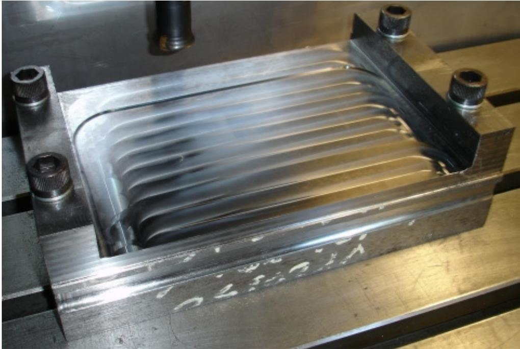
**Figura 3.11:** Montagem peça e operação de faceamento de topo utilizados nos testes de usinagem.
