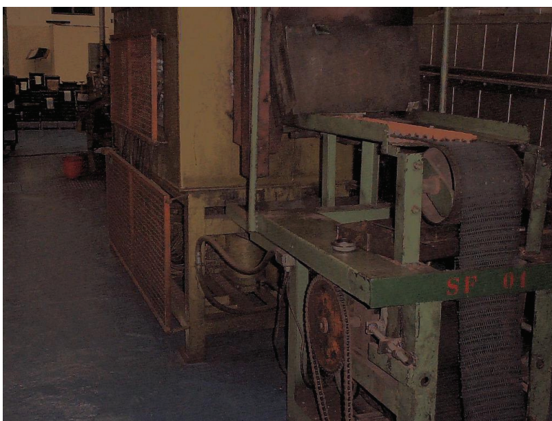
Figura 3.6. Forno contínuo (entrada) utilizado para promover a ligação das partículas metálicas (Cortesia da Forjisinter Ind. e Com. Ltda.).
