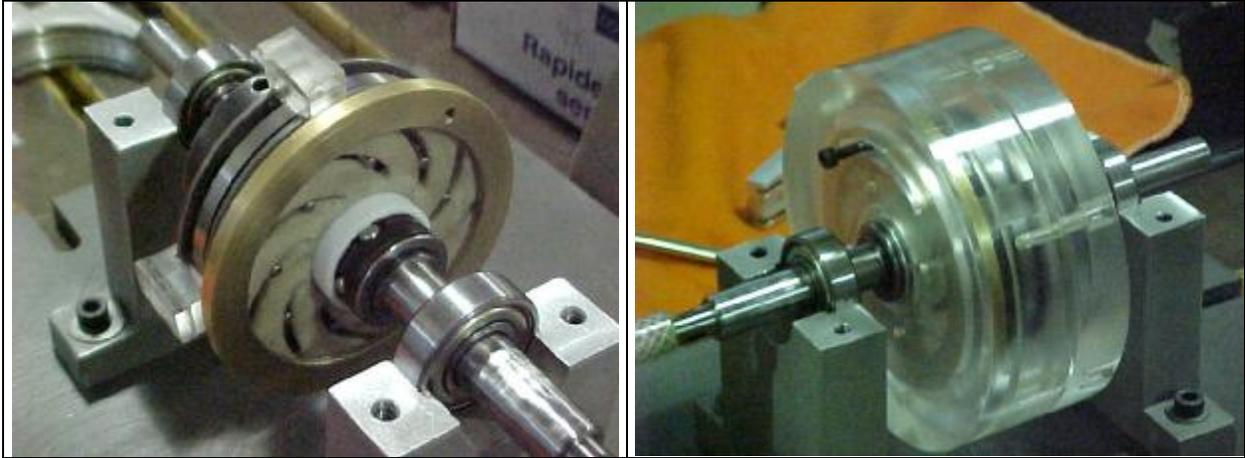
**Figura 5.20-** Partes da TD-CVT 3
