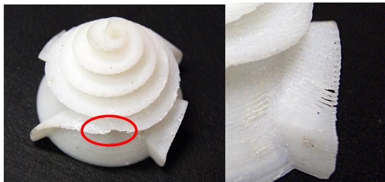
Figura 3.17 – Imperfeições provenientes do processo de FDM.
