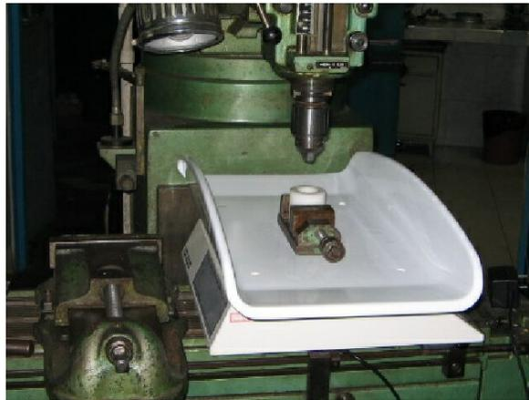
Figura 4.10 – Bancada desenvolvida para os testes de atrito com sistema digital de medição da carga.
