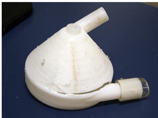
Figura 3.21 - Protótipo em ABS com a saída danificada.
