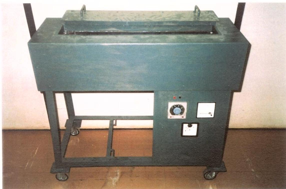
Figura 4.5 - Forno de cuba, para simulação do resfriamento natural de bobinas
