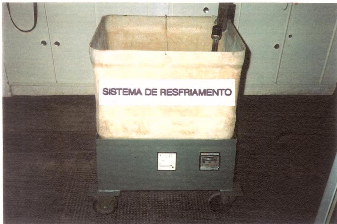
Figura 4.4 - Aparato para simulação do resfriamento acelerado
