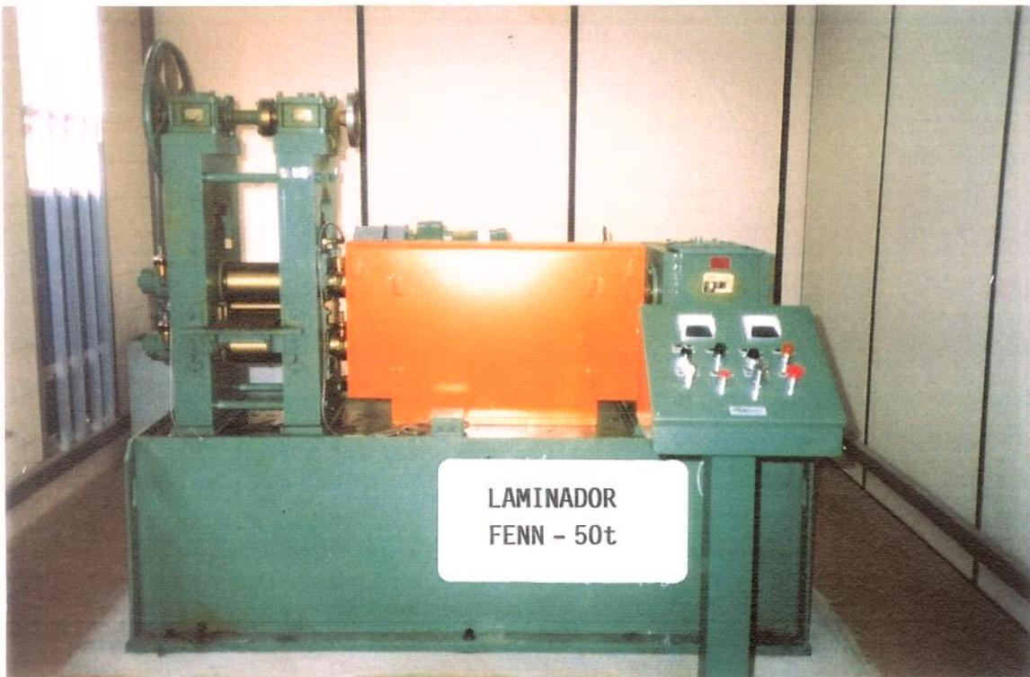
Figura 4.3 - Laminador FENN-051, para simulação da laminação controlada
