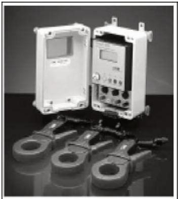
Figura B1 – Analisador de energia SAGA 4000
