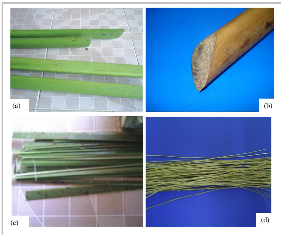
Figura 4.3 – Obtenção da fibra de *miriti* (a) e (b) pecíolo do buriti, (c) talas largas, e (d) fibras de *miriti* (Autor, 2009).
