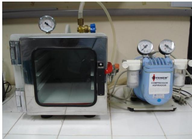
Figura 4.7 – Dessecador e bomba de vácuo usados na secagem das fibras.
