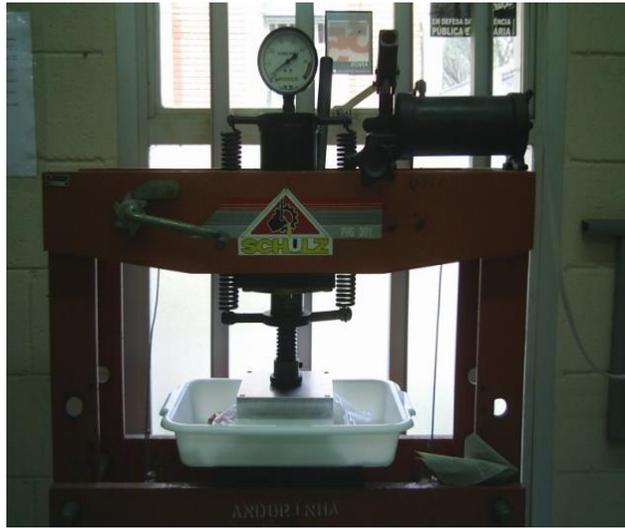
Figura 4.11 – Prensa hidráulica utilizada na moldagem das placas.
