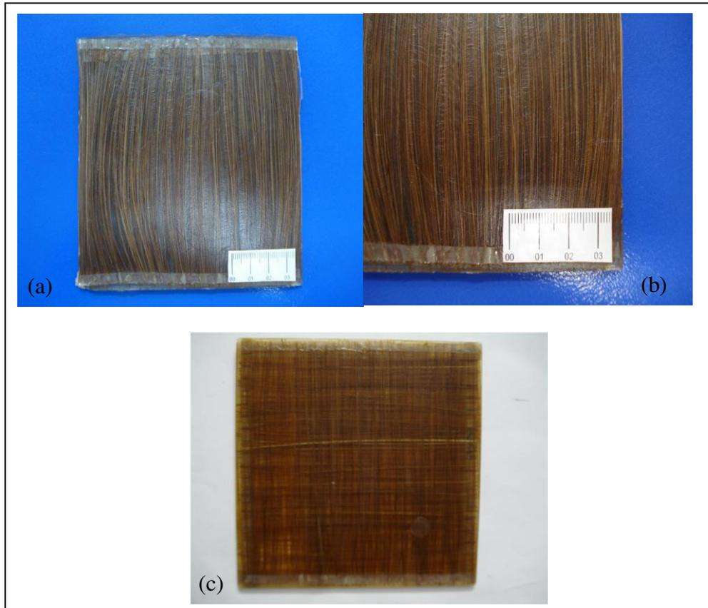
Figura 5.13 – Placa de compósito unidirecional (a) e (b), e placa de compósito bi-direcional (c).
