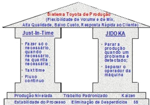
Figura 2 Estrutura do Sistema Toyota de Produção, adaptado de Ohno (1997).
