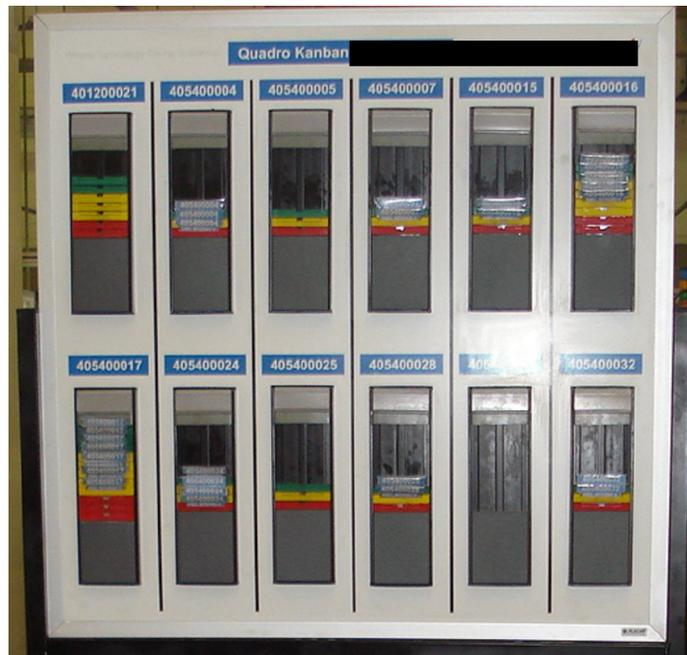
Figura 41 Quadro kanban, Célula de Porcas de Roda.
