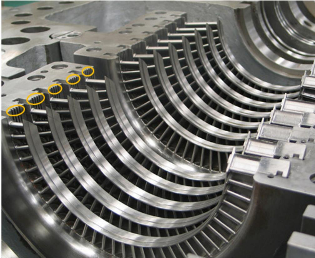
Figura 2.12 - Turbina de reação alta pressão e alta temperatura, modelo BT/BTE (Selo tipo labirinto), TGM.
