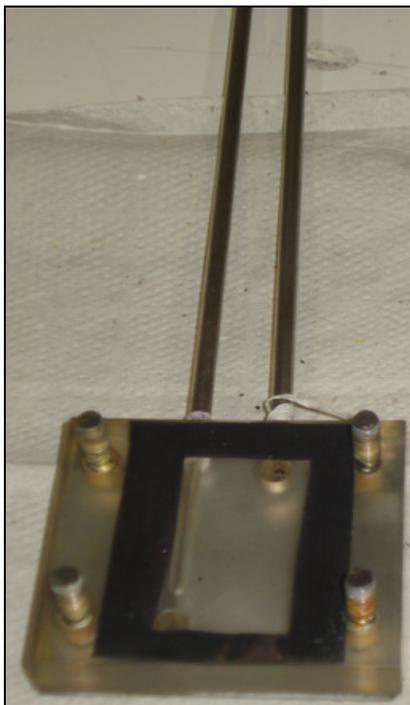
Figura 3.9: Ilustração da parte interna do arranjo onde o eletrodo é inserido.
