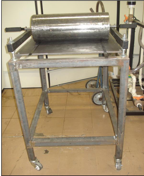
Figura 3.7: Ilustração do cilindro utilizado para laminar o eletrodo.
