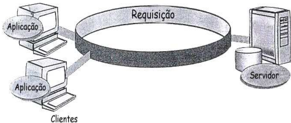
Figura 2.9: A estrutura básica de requisição/atendimento a processos na arquitetura C/S (adaptado de Orfali, 1994).
