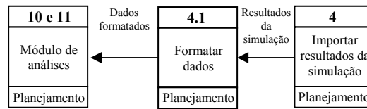
Figura 4.31: D.F.D. de nível 1 para a importação de dados da simulação.
