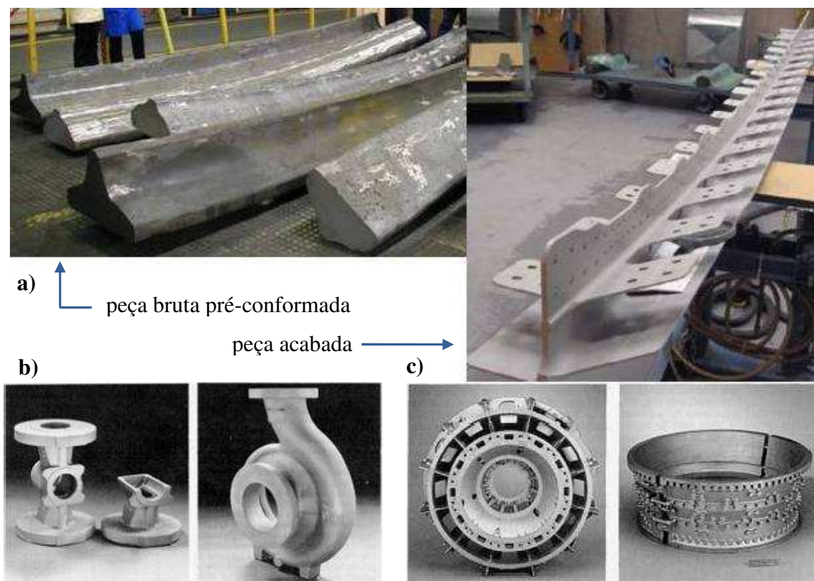
Figura 2.2 Exemplo de componentes confeccionados em titânio: (a) corda de junção asa-fuselagem (adaptado de DENKENA, KÖHLER E DEGE, 2008), (b) válvula e bomba para indústria química e (c) turbina a gás (adaptado de EYLON, NEWMAN e THORNE, 1990)
