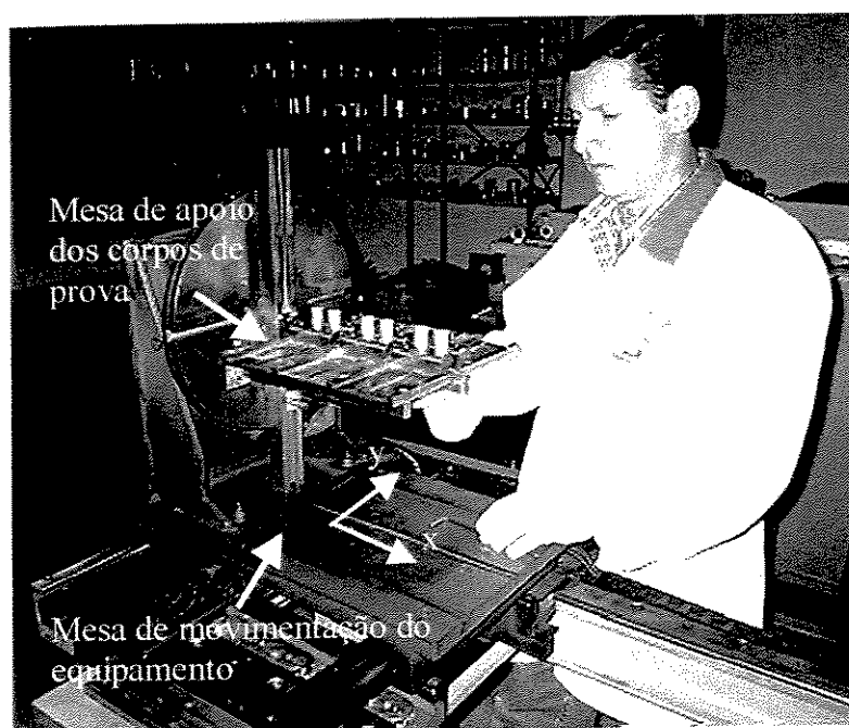
Figura 3.3 - Esquema de montagem dos corpos de prova para realização do ensaio.
