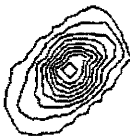
Figura 4.4 - Distribuição de energia dentro de um feixe de elétrons. ( Powers & Laflamme, 1991 ).
