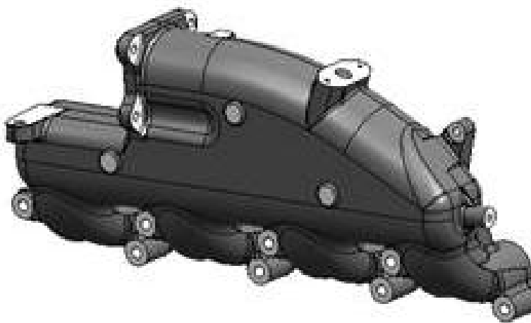
FIGURA 4. Coletor de admissão – peça selecionada para este trabalho. Fonte: Arquivo 3D - Motor Sprint 3.2 – MWM International Motores
