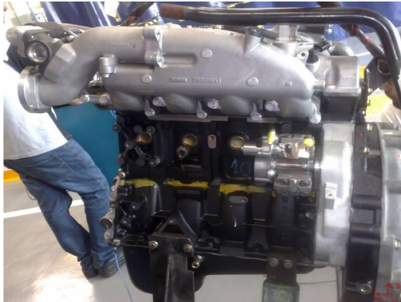
FIGURA 15. Foto do coletor em estudo feito em liga de Alumínio.
