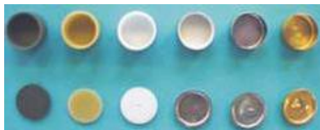
FIGURA 39. Cadinhos utilizados no DSC (grafite, ZrO_2 , Al_2O_3 , Pt + Al_2O_3 inside layer Pt, Au) e haste do DSC de fluxo de calor
