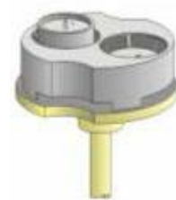
FIGURA 39. Cadinhos utilizados no DSC (grafite, ZrO_2 , Al_2O_3 , Pt + Al_2O_3 inside layer Pt, Au) e haste do DSC de fluxo de calor
