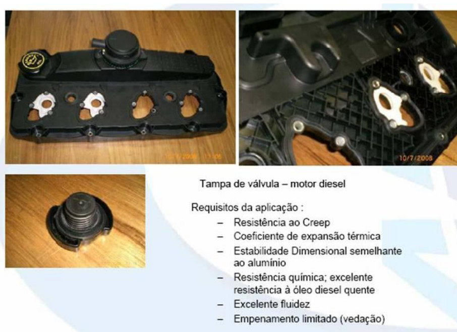
FIGURA 12. Exemplo de peça MWM em poliamida 66: tampa de válvula de motor a diesel
