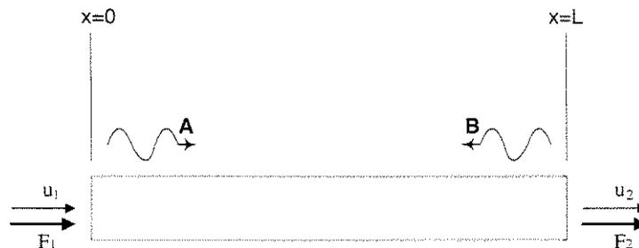
*Figura 4.5 – Componentes de onda em elementos de barra.*
