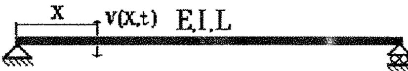
Figura 8.20 - Viga Biapoiada
