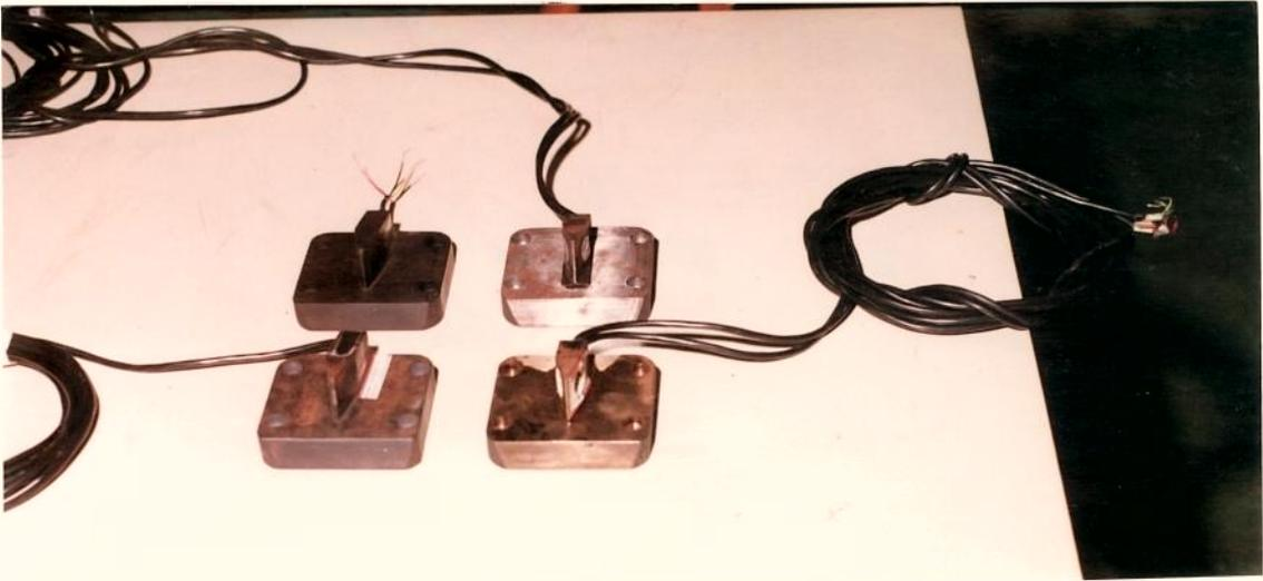
Figura 3.9. As células de carga  $C_I$ ,  $C_{II}$ ,  $C_{III}$  e  $C_{IV}$ , prontas para ensaio em condições reais de carregamento.
