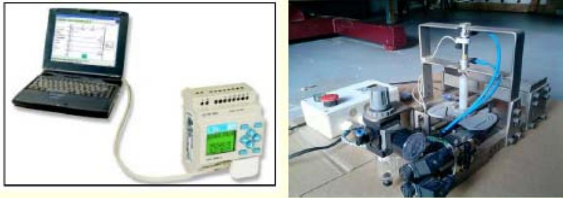
Figura 3.16- (a) Controle de ensaio do fecho; (b) dispositivo de ensaio ciclos de fecho.
