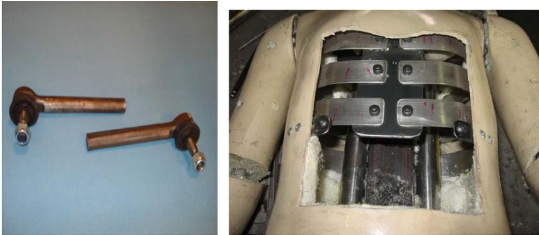
Figura 3.14 - (a) Terminais de ligação dos membros; (b) Caixa toraxica do boneco.
