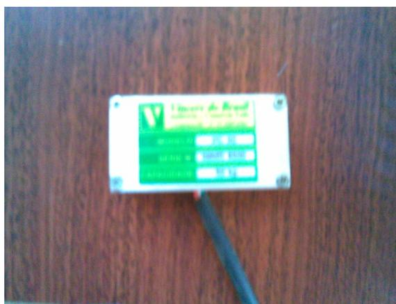
Figura 3.1 – Célula de Carga utilizada no Ensaio
