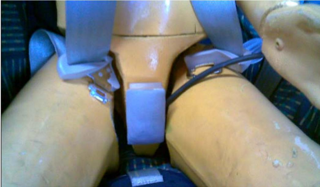
Figura 3.3 - Ponto de instalação da célula de carga
