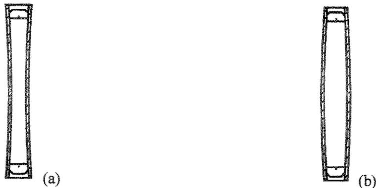
Figura 2.6 Deformação numa janela de vidro duplo com gás devido a mudanças na pressão e temperatura.
