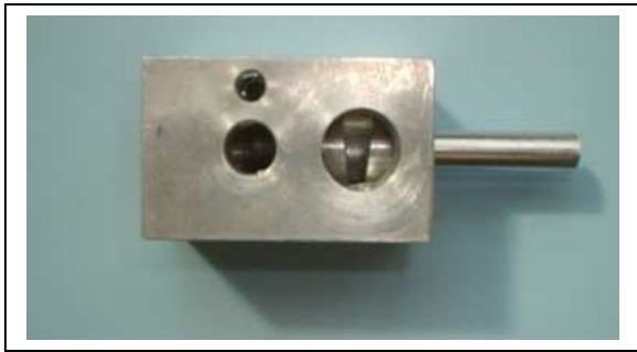
Fig. 5.22 – Construção da 2ª Válvula de Comando
