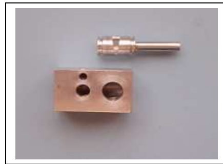
Fig. 5.23 – Construção da 2ª Válvula de Comando
