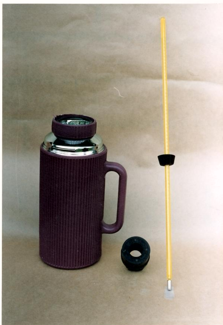
FIG. A5.1. CALORIMETRO PARA MEDIDA DA TEMPERATURA DO SÓLIDO NA SAÍDA DO SEPARADOR GRAVITACIONAL.
