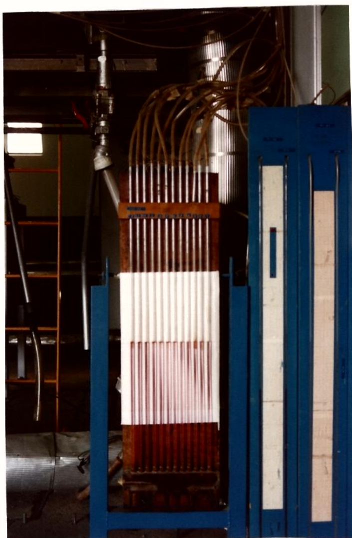
FIG. 2.16. MULTIMANÔMETRO, PDI-05, PARA MEDIDA DOS DIFERENCIAIS DE PRESSÃO AO LONGO DO TUBO DE TRANSPORTE
