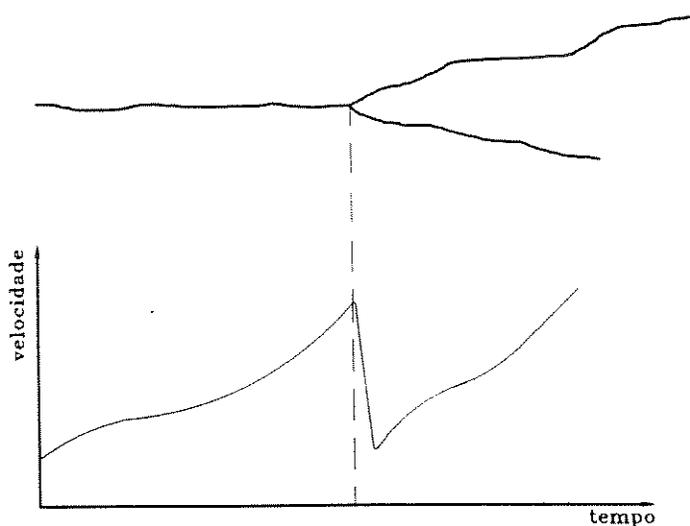
Figura 2.2: Ramificação e velocidade de propagação da trinca submetida a esforços dinâmicos.
