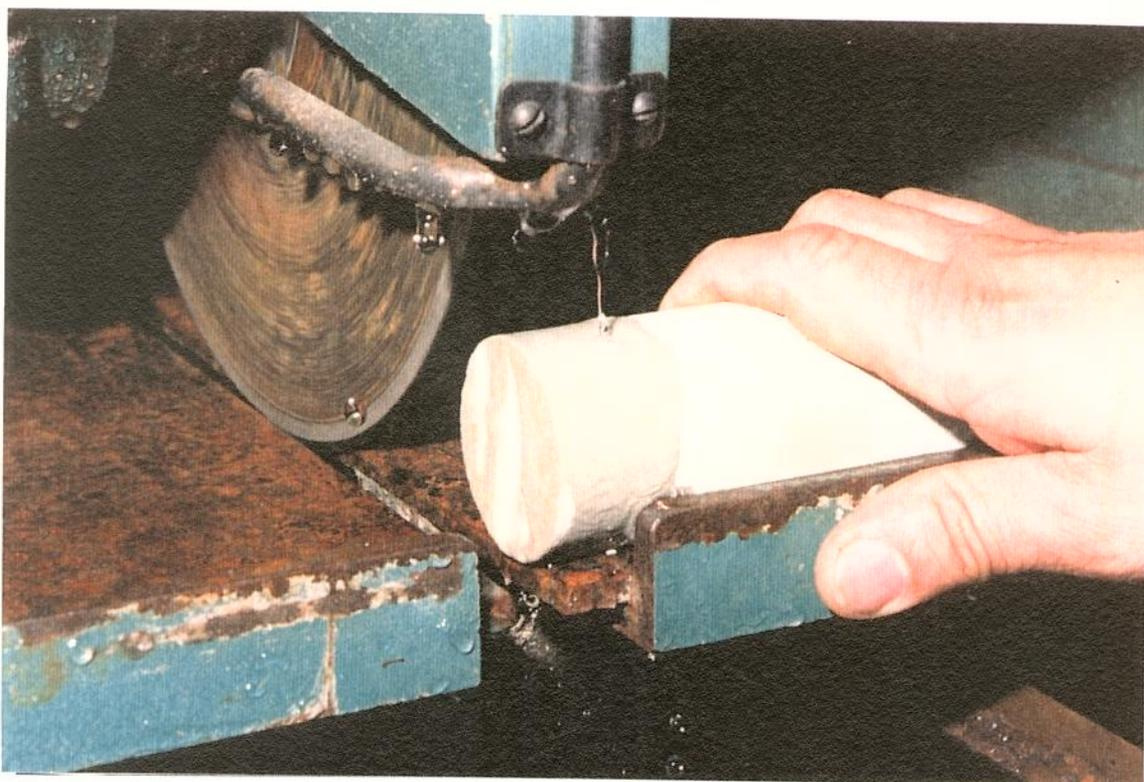
**Figura 4.7 - Processo de corte das extremidades do CP.**
