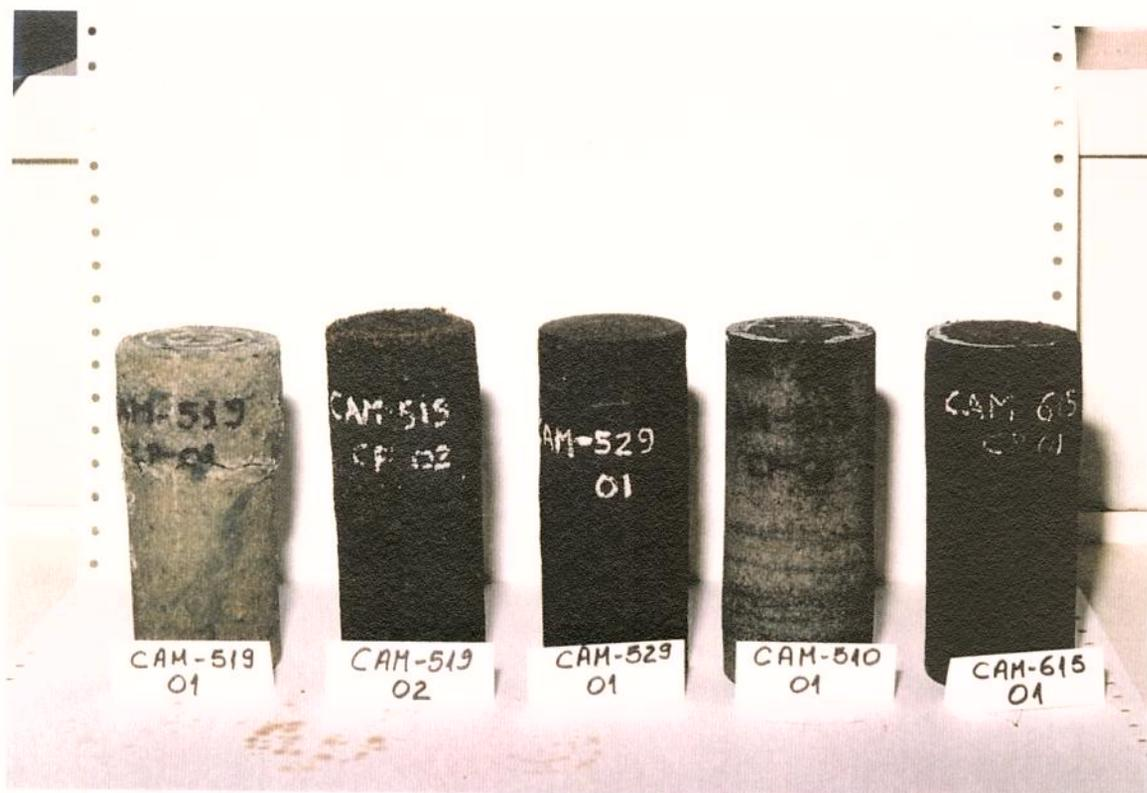
**Figura 5.68 - CP CAM-519/01, CAM-519/02, CAM-529/01, CAM-510/01, CAM-615/01 utilizados nos ensaios de compressão triaxial múltiplos.**
