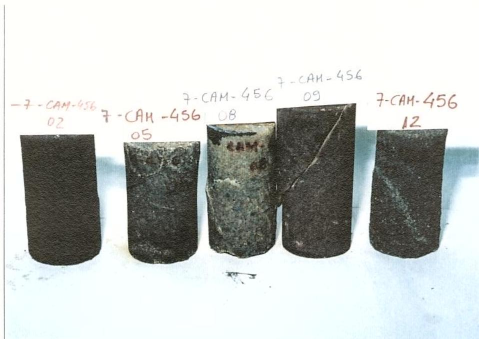
**Figura 5.65 - CP CAM-456/02, CAM-456/05, CAM-456/08, CAM-456/09, CAM-456/12 utilizados nos ensaios de compressão triaxial convencionais.**
