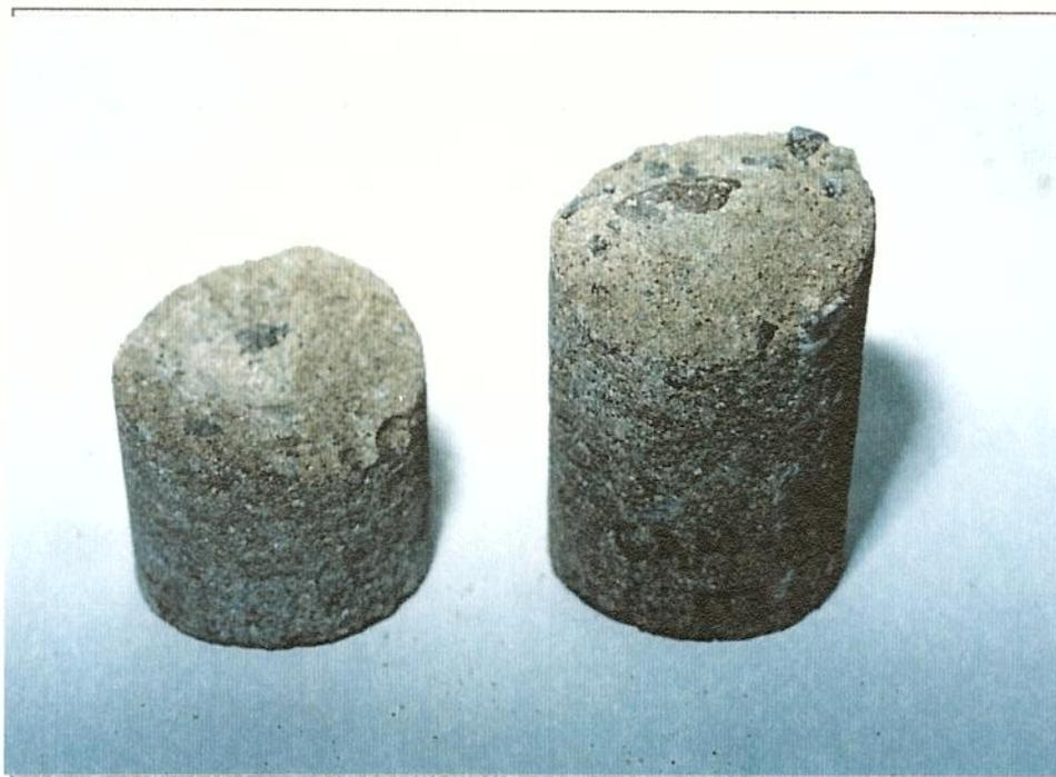
Figura 4.3 - CP do poço CAM-373 (lote 2) que não chegou a ser ensaiado por ter quebrado durante a amostragem. Atentar para a má seleção dos grãos da rocha.
