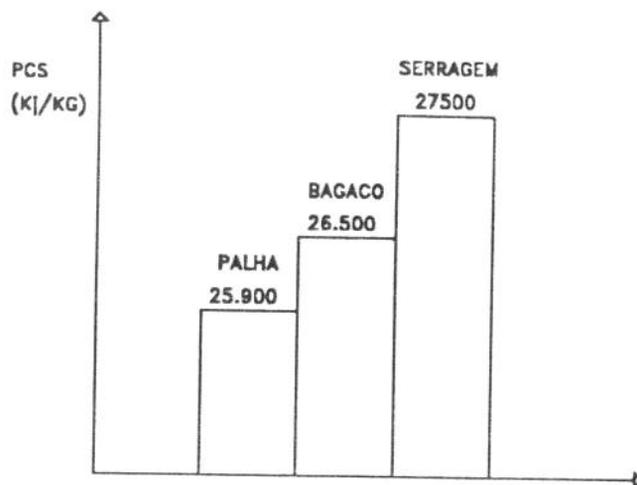
Fig. 17. Gráfico dos briquetes pirolisados de serragem, bagaço e palha de cana a taxas de aquecimento de  $2^{\circ}\text{C}/\text{min}$  e temperatura final de pirólise de  $400^{\circ}\text{C}$ .
