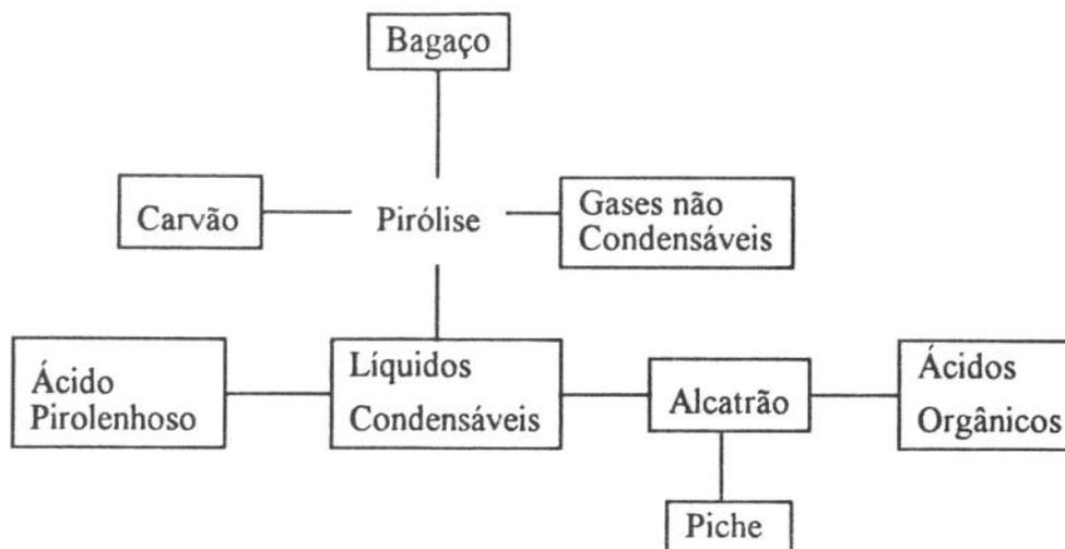
Fig. 14. Fluxograma do processo de produção de piche e carvão a partir da pirólise do bagaço de cana [33].
