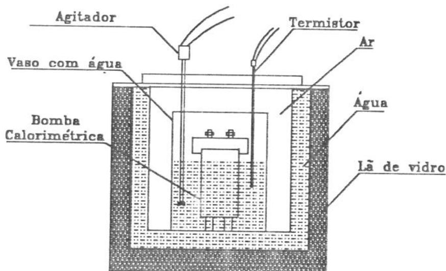
Fig. 11. Esboço do calorímetro isoperibólico utilizado nos ensaios para determinação do PCS [34].
