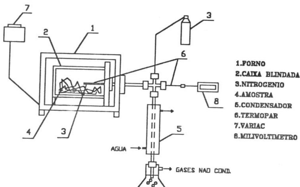
Fig. 9. Esboço do sistema de pirólise com taxas de aquecimento controladas e atmosfera inerte (nitrogênio).
