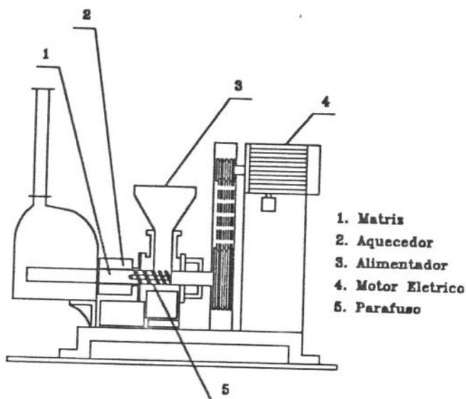
Fig. 5. Esboço de extrusora termoplástica para biomassas.
