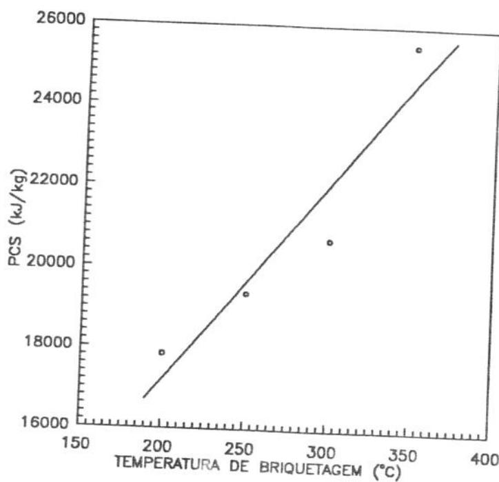
Fig. 15. Gráfico do PCS dos briquetes de bagaço de cana em função da temperatura de briquetagem.
