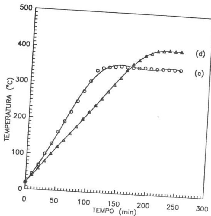
Fig. 10. Gráficos Temperatura x Tempo da caixa de carbonização sem amostra para aferição do sistema de pirólise.
