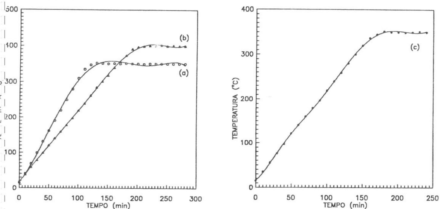
Fig. 13. Gráfico Temperatura x Tempo da amostra coletados no interior da caixa de carbonização (local onde se encontra a amostra).
