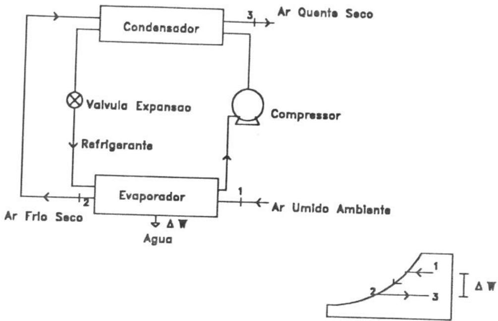
Fig. 4. Esquema do ciclo da bomba de calor.
