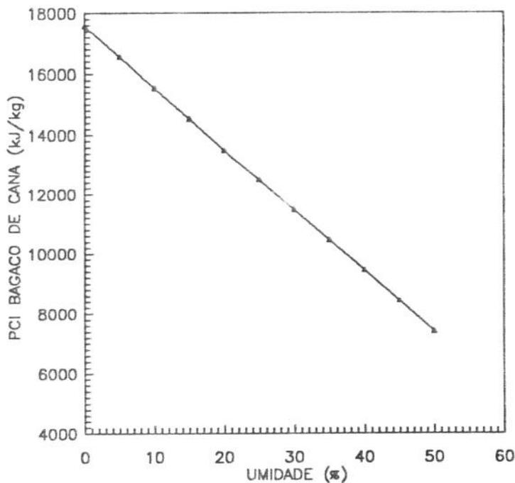
Fig.3. Gráfico do PCI do bagaço em função da umidade [7].
