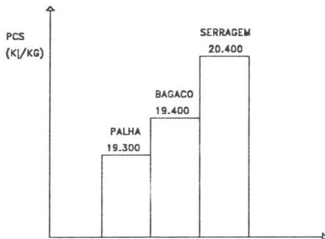
Fig. 16. Gráfico do PCS dos briquetes de serragem, bagaço e palha de cana compactados a 250°C.
