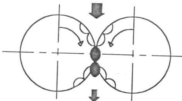
Fig. 6. Esquema da prensa de cilindros giratórios com iguais diâmetros.
