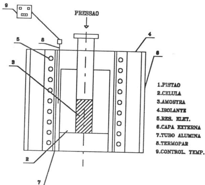
Fig. 7. Esboço do sistema de briquetagem a quente.
