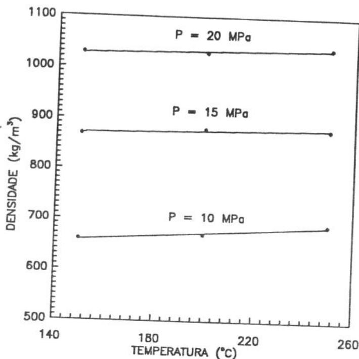
Fig. 18. Variação da densidade do briquete em função da pressão e temperatura de briquetagem nos ensaios do item i.
