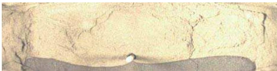
Figura 2-29 – Fotografia de seção longitudinal (x=30cm) da célula após o experimento de Greaves e Turta (2003)
