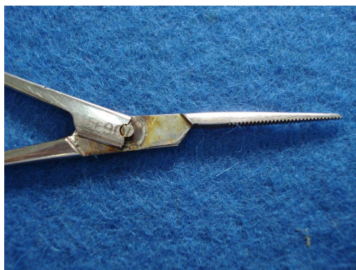
Figura 41 – Fratura na junção macho e fêmea no local de encaixe do pino – câmera fotográfica
