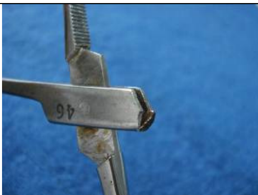
(a) fratura na junção macho e fêmea – câmera fotográfica
