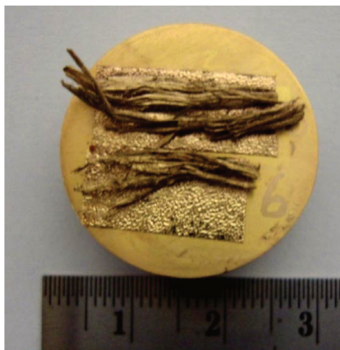
Figura 39. Partícula típica da amostra 2 elutriada com velocidade de 2,227 m/s revestida de ouro para análise de imagem no MEV
