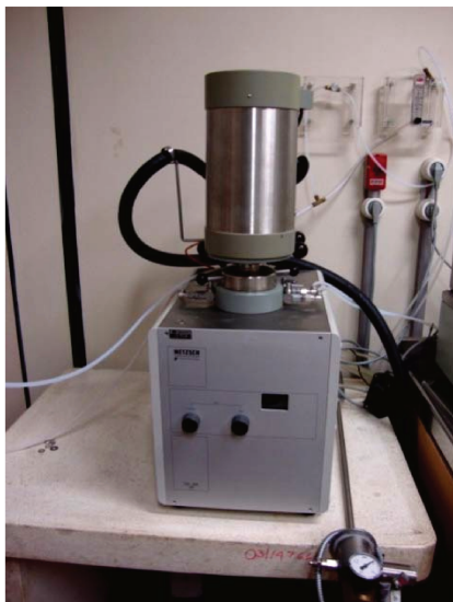
Figura 35. Balança termogravimétrica Netzsch STA 409
