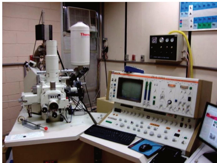
Figura 37. Microscopia Eletrônica de Varredura e Microanálise (MEV), modelo JEOL JXA-840 A
