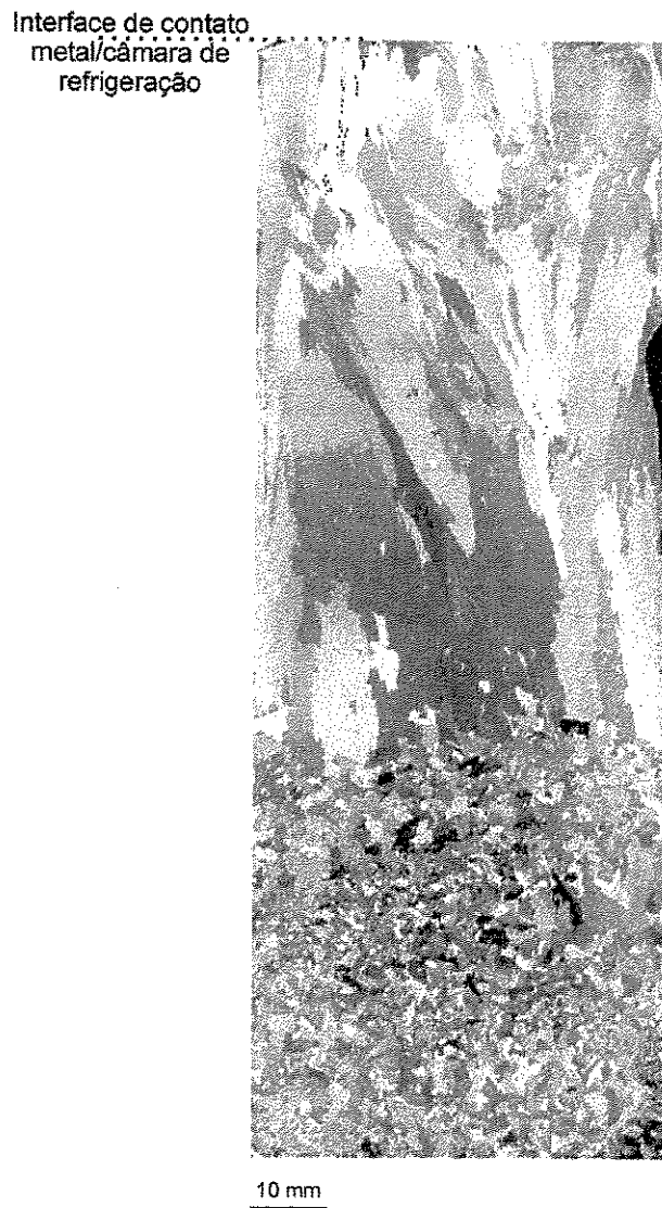
Figura 5.15. Macroestrutura da liga Sn15%Pb, para molde polido e superaquecimento de 10% acima da temperatura liquidus ( \Delta T_v = 21^\circ\text{C} ).
