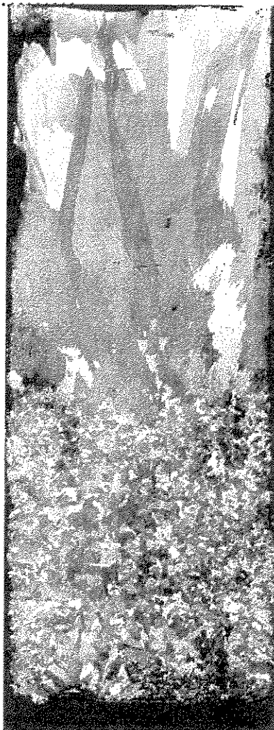
Figura 5.13. Macroestrutura da liga Sn15%Pb, para molde polido e \Delta T_v = 7^\circ\text{C} .
