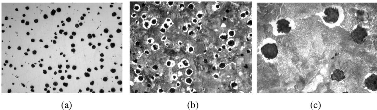
Figura 4.1 (a). Fofu nodular aumento 100x sem ataque. (b) Fofu nodular aumento 100x com ataque de nital a 3%. (c) Fofu nodular aumento 500x com ataque de nital a 3%.
