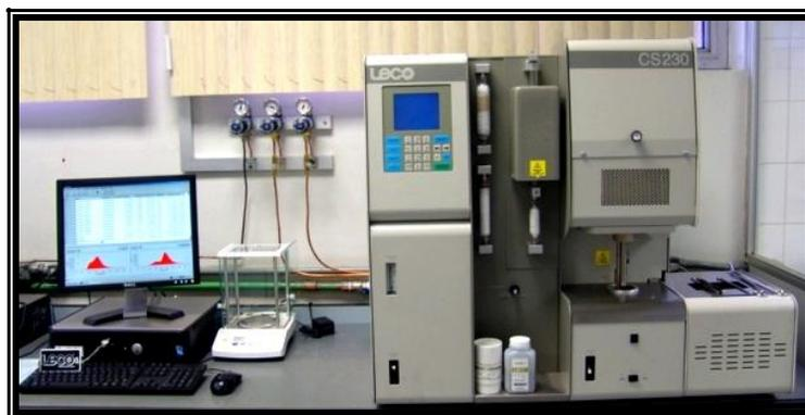
Figura 3.11. Equipamento Leco série CS 230 para análise da porcentagem de carbono e enxofre.
