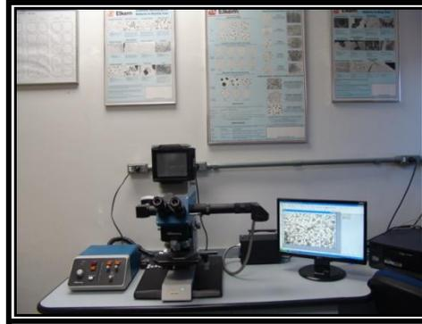
Figura 3.12. Foto do microscópio óptico POLYVAR Reicheter-Jung.
