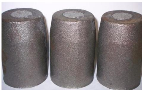
Figura 3.1. Fofu nodular perlítico, sem beneficiamento, material fornecido pela empresa Tupy para a confecção dos corpos de prova.
