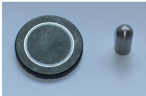
Figura 4.4. Foto Pino ADI G3 e disco após ensaio.
