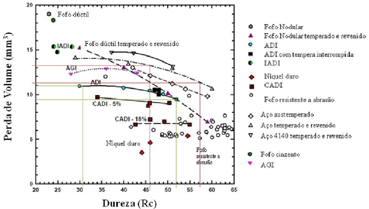
Figura 2.6. Ensaio comparativo de abrasão em pino para o ADI, aço e ferro fundido. Perda de volume em mm<sup>3</sup> x dureza Rc [Hayrynen, 2007].
