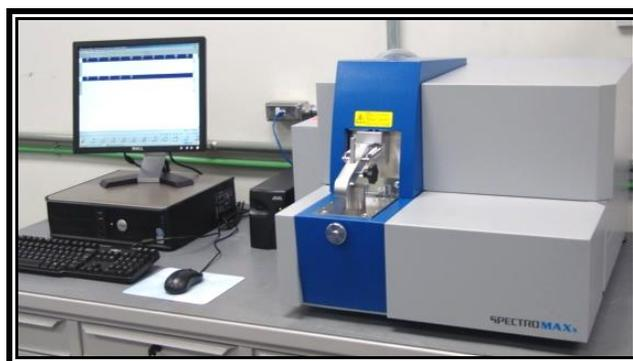
Figura 3.10. Equipamento SpectroMax para análise de composição química.
