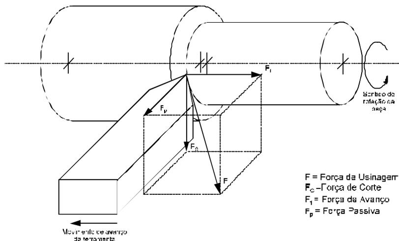
Figura 2.9 Componentes da força de usinagem no torneamento, nos planos de trabalho e efetivo de referência, segundo a norma DIN 6584.
