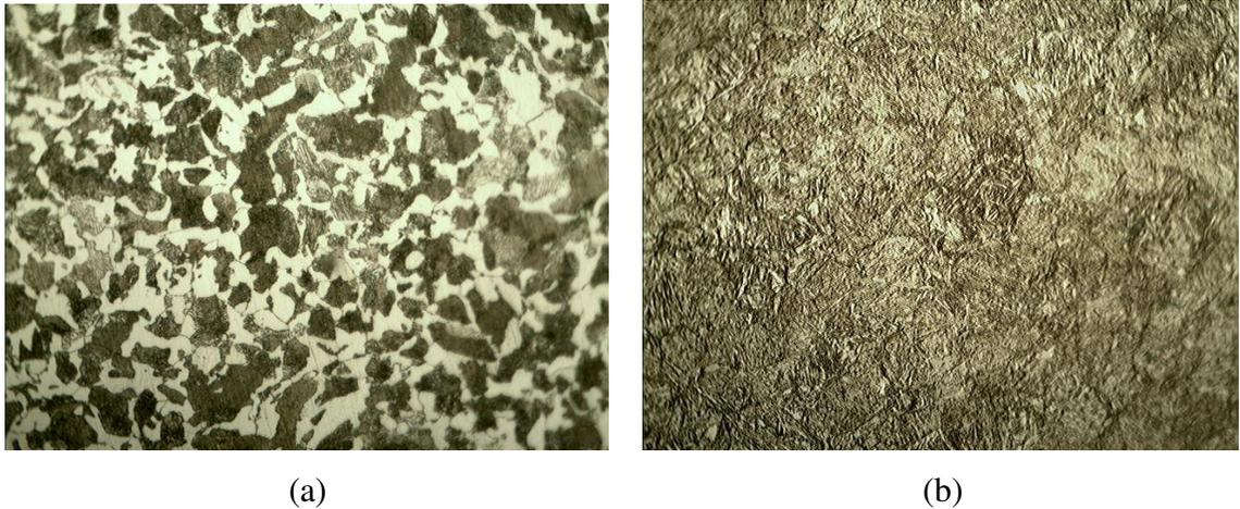
Figura 4.2 aço SAE 1045 (a) núcleo sem tratamento térmico aumento 325x com ataque de nital a 3%. (b) superfície temperada e revenida aumento de 100x com ataque de nital a 3%.
