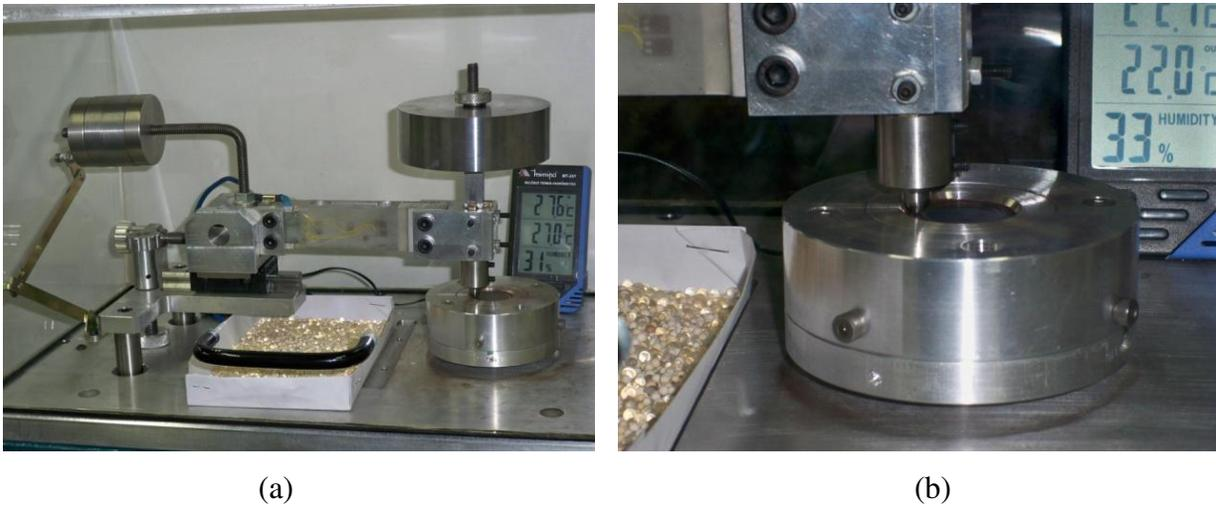
Figura 3.3(a) tribômetro para ao ensaio de Pino sobre disco (b) detalhe pino e disco.
