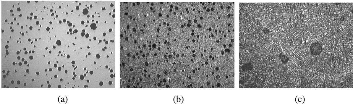
Figura 4.3 ADI grau 3 (a) aumento 100x sem ataque. (b) aumento 100x com ataque de nital a 3%.
