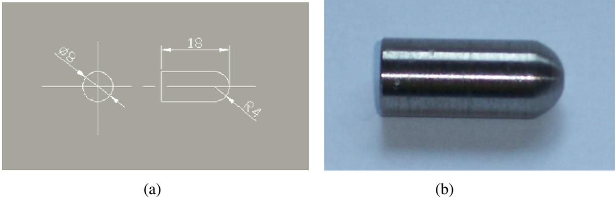
Figura 3.4 (a) dimensões do pino para ensaio pino sobre disco (b) foto do pino do ensaio pino sobre disco.
