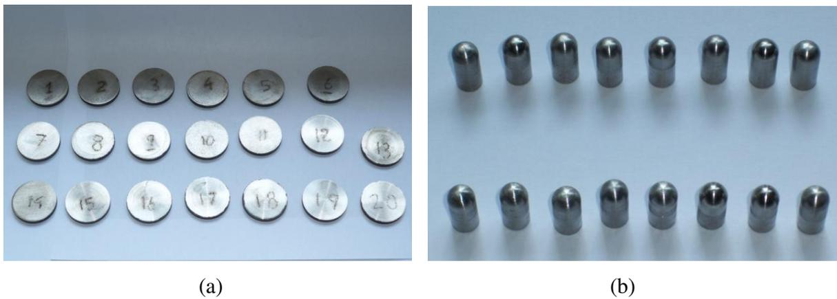
Figura 3.7 Corpos de prova fabricados para o ensaio de desgaste pino sobre disco. (a) discos e (b) pinos.
